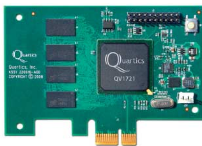
Spezial-Chips wie die SpursEngine (auf der Leadtek-Karte, links) und der Quartics QV1721 sollen das Transkodieren und die Wiedergabe von HD-Video beschleunigen.
