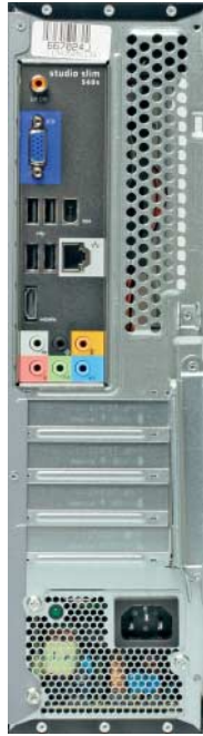
An die Laufwerke des Studio Slim kommt man ohne Schraubendreher heran; Steckkarten passen nur, wenn sie besonders flach (Low Profile) sind.
