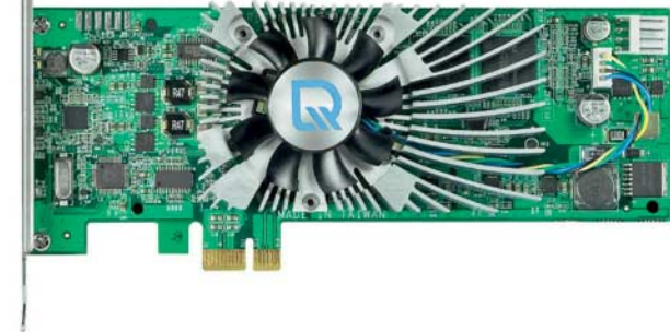
Spezial-Chips wie die SpursEngine (auf der Leadtek-Karte, links) und der Quartics QV1721 sollen das Transkodieren und die Wiedergabe von HD-Video beschleunigen.
