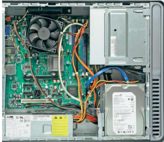
An die Laufwerke des Studio Slim kommt man ohne Schraubendreher heran; Steckkarten passen nur, wenn sie besonders flach (Low Profile) sind.
