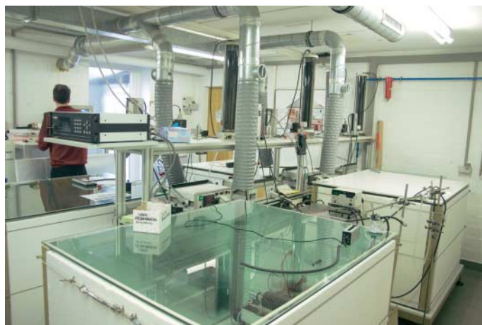
Prüfkammern zur Emissionsmessung im Wilhelm-Klauditz-Institut Braunschweig: „Hunderte Drucker in die Kammer“.
