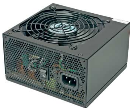
Silverstone SST-ST60EF: Stützzeit bei 12 V deutlich zu kurz, sonst aber überdurchschnittliche Störimmunität, hoher Wirkungsgrad
