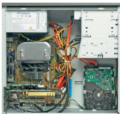
Die Hauptverantwortung für den Geräuschpegel des Targa Now 8821 trägt der unnötig laute 4-cm-Lüfter auf der Grafikkarte.
