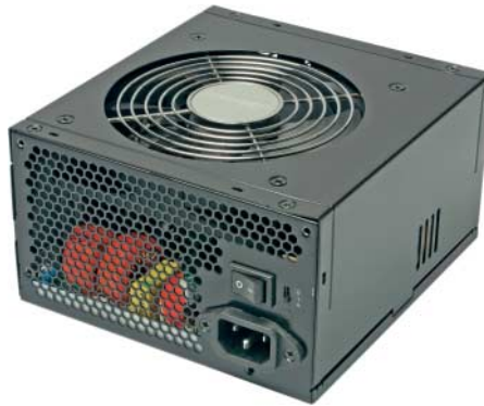
CobraNitrox IT-7600SG: 80-plus-Schwelle bei schwacher Last knapp geschafft, bei Volllast recht laut, aber gute Störfestigkeit
