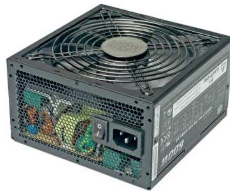
Cooler Master RS-600-AMBA-D3: hohe Stützzeit, auch im Standby, guter Wirkungsgrad, obendrein wenig Geräuschentwicklung
