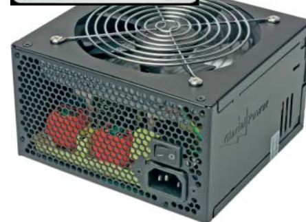
GlacialPower GP-AL550AA: hohe Stützzeit bei 5 V und 12 V sowie gute Effizienz im Betrieb, durchschnittliche Ausstattung
