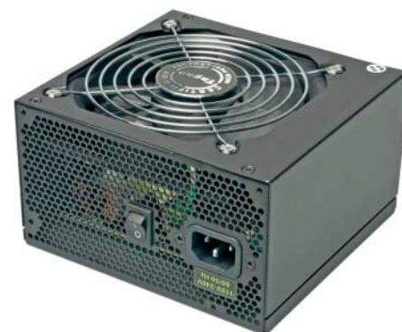
Tagan TG600-U33II: geringe Verluste im Standby-Betrieb, noch erträglich laut bei hoher Last, mäßig störimmun
