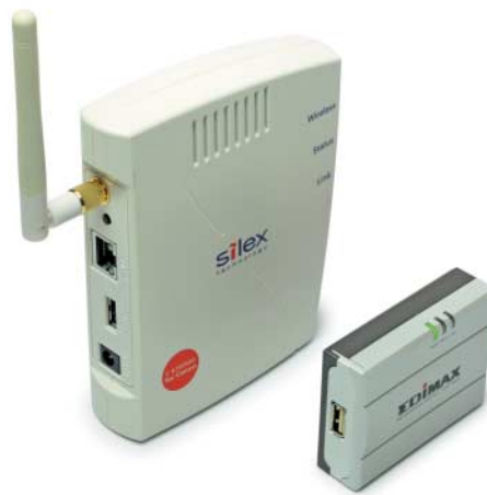
Device-Server, die USB-Geräte via Ethernet verbinden, gibt es in verschiedensten Varianten von günstigen Spezialisten für USB-Drucker wie dem Edimax PS-1216U (rechts) bis zu Allround-Talenten wie dem Silex C-6700WG.
