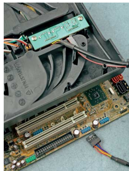
Die frontseitigen USB-Buchsen von PC-Gehäusen sind manchmal mit erbärmlich schlechten Kabeln ausgestattet.
