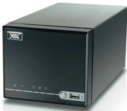
NAS-Server zum Selberbauen: Der Artigo A2000 nimmt zwei 1,5-Terabyte-Platten auf und läuft unter Windows, Linux oder FreeBSD.
