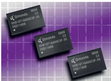
Auf Qimondas Buried-Wordline-Chips ruhen alle Hoffnungen (hier 1 GBit, 65 nm).
