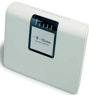
T-Home verzichtet beim Speedport W 503V auf einige Funktionen der zugrunde liegenden Fritz!Box.
