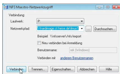
Den Netzwerkpfad des NFS-Servers bildet der Maestro-Client unter Windows auf einen Laufwerksbuchstaben ab.
