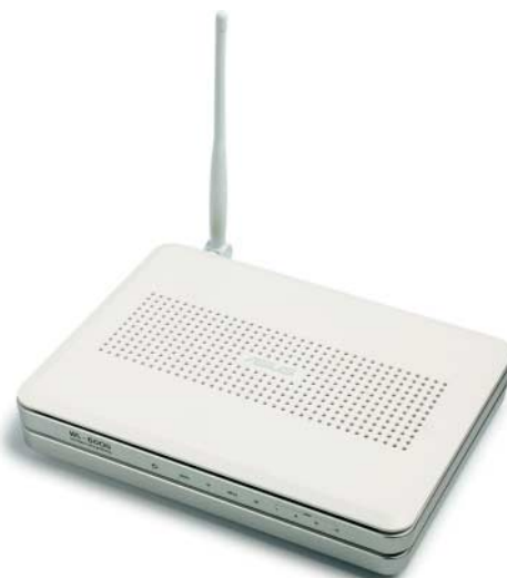
Der Asus WL-600g bietet gleich zwei USB-Anschlüsse für Drucker und Festplatten und Zusatzfunktionen wie VLANs.
