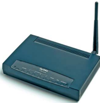
Der Zyxel P-661HW-D7 verstand sich auf kurzer Strecke nicht optimal mit dem Test-DSLAM von Siemens.
