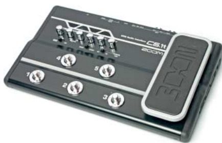
Das Audio-Interface zur Simulations-Software dient gleichzeitig als Fußtreter.
