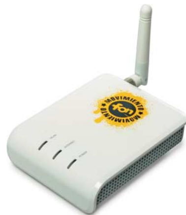
Der Access-Point von Fon hängt an einem Ethernet-Port des heimischen DSL-Routers und sorgt für den Zugang von WLAN-Fon-Nutzern.
