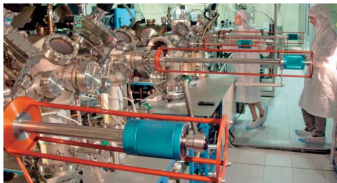
In der MBE-Anlage (Molecular Beam Epitaxy) am französischen Forschungszentrum CRHEA werden weiße LEDs erzeugt, die ohne Phosphorbeschichtung auskommen.
