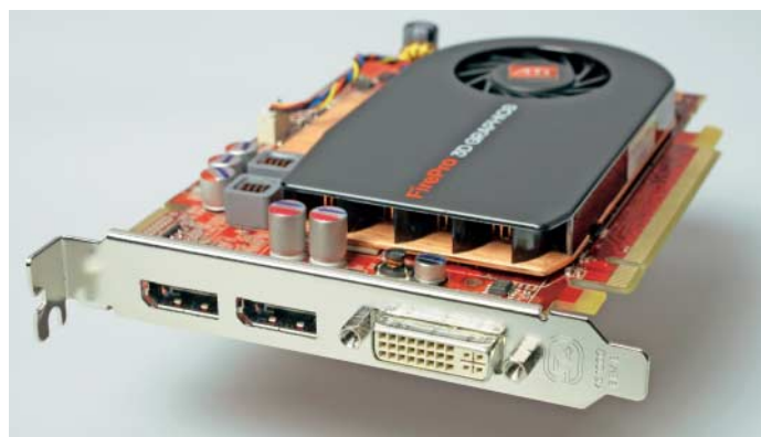
AMD und Nvidia ersetzen bei neueren Workstation-Grafikkarten die zweite DVI-I-Buchse durch Anschlüsse nach dem DisplayPort-Standard.
