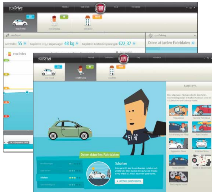
Am PC wertet die Eco:Drive-Applikation anhand der Daten vom USB-Stick das Fahrverhalten des Nutzers aus und gibt Tipps, wie sich Kraftstoff und CO 2 einsparen lassen.
