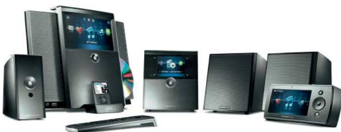
Die Cisco-Medienabspieler beschallen gleichzeitig mehrere Räume und übertragen MP3-, Ogg-Vorbis- und Flac-Dateien über WLAN oder Ethernet.
