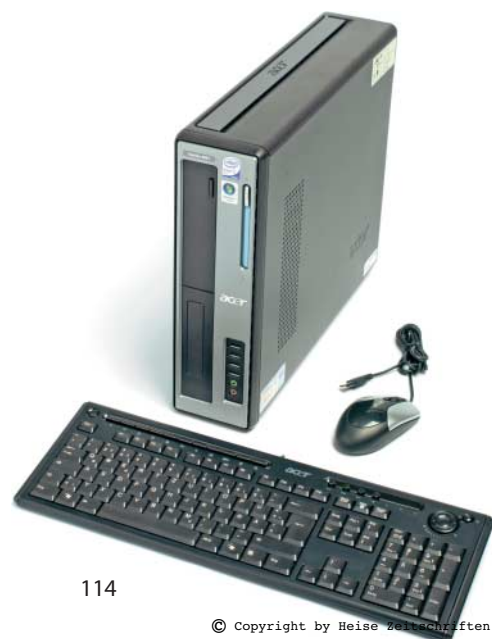
Mit nur 1 GByte ist der Arbeitsspeicher des Acer Veriton S661 für Windows Vista zu knapp bemessen.
