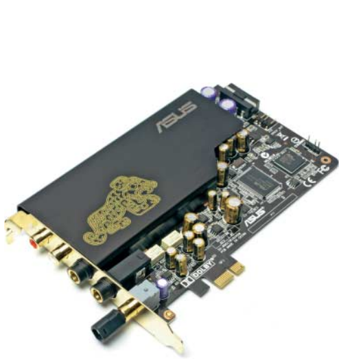
Die Asus Xonar Essence STX setzt sich vom übrigen Feld mit Kopfhörerverstärker und 6,3-mm-Klinkenanschluss ab.
