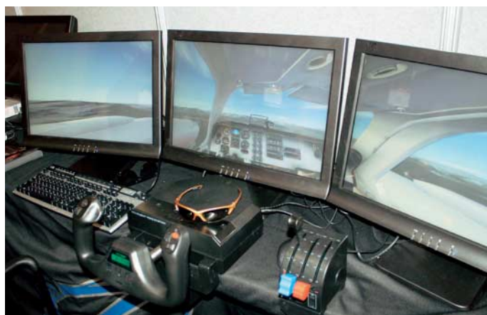
Flugsimulation in 3D auf drei IZ3D-Monitoren, angeschlossen an eine Matrox-Grafikkarte mit TripleHead2Go-Adapter
