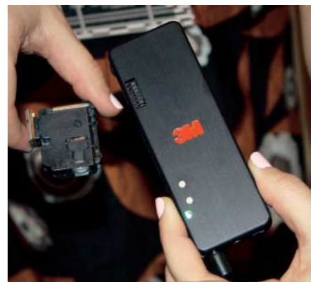
Außer einem Minibeamer bietet 3M ein Beamermodul für den Einbau in Mobilgeräte an.
