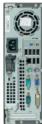
Für Geräte mit serieller Schnittstelle stehen auf der Rückseite des Fujitsu Siemens Esprimo C5730 zwei RS-232-Buchsen bereit.
