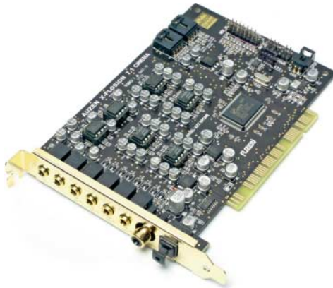
Auzentechs X-Plosion 7.1 Cinema bringt einen AC3/DTS-Encoder mit. Analog klingt sie aber schlechter als Onboard-Sound.
