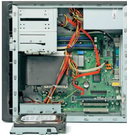
Extra Computer hängt im Exone Professional 4060 E8500 die Festplatte schwingungsentkoppelt auf.
