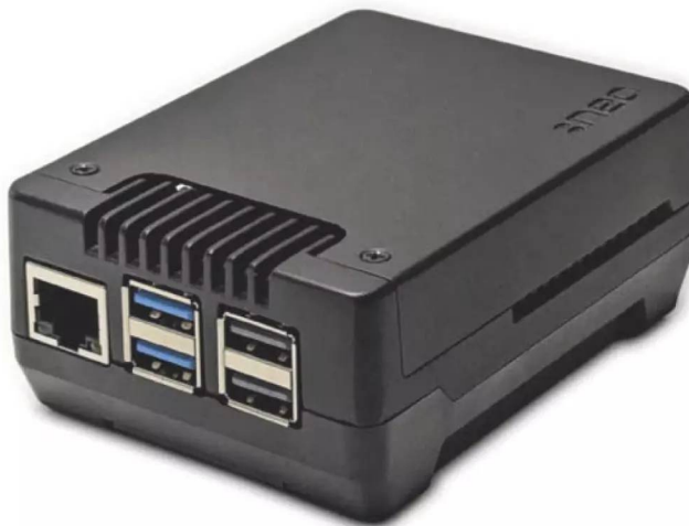
Klein, aber oho: In diesem kompakten Gehäuse steckt ein Raspi 5 mit einer flotten M.2-SSD, die bis zu 8 TByte fassen kann.
