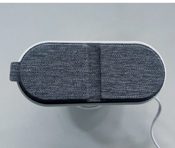
Privatmodus mit Augenklappe. So ist sichtbar: Die Kamera filmt nicht (Abus Innenkamera).
