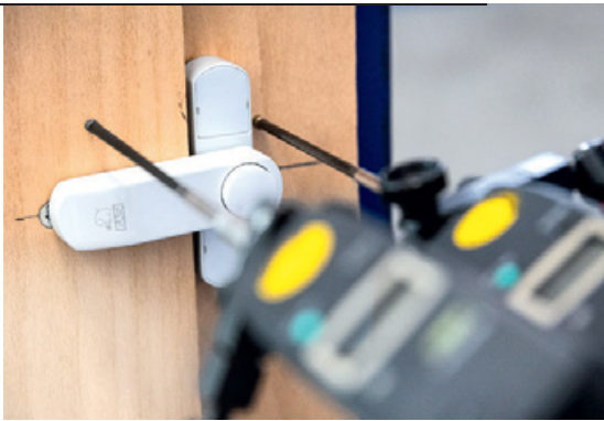
Druck. Die Sicherungen mussten einer Belastung von gut 600 Kilogramm trotzen.
