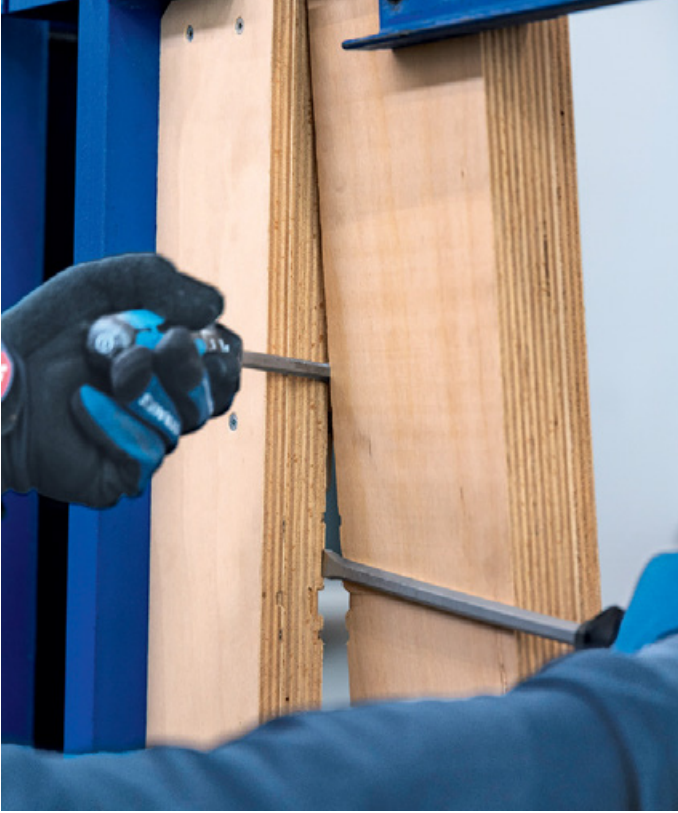
Aufhebeln. So versuchen Einbrecher am häufigsten, Fenster zu öffnen – deshalb versuchte unser Prüfteam es auch.
