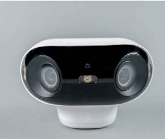
Doppelt. Zwei Kameras ermöglichen breiteren Blickwinkel (Reolink Argus).
