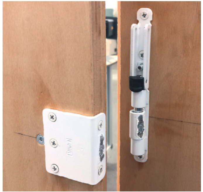
Aufgegeben. Unter dem Druck unserer Prüfer gaben manche Schweißnähte nach – wie hier bei der Sicherung von Fuhr.
