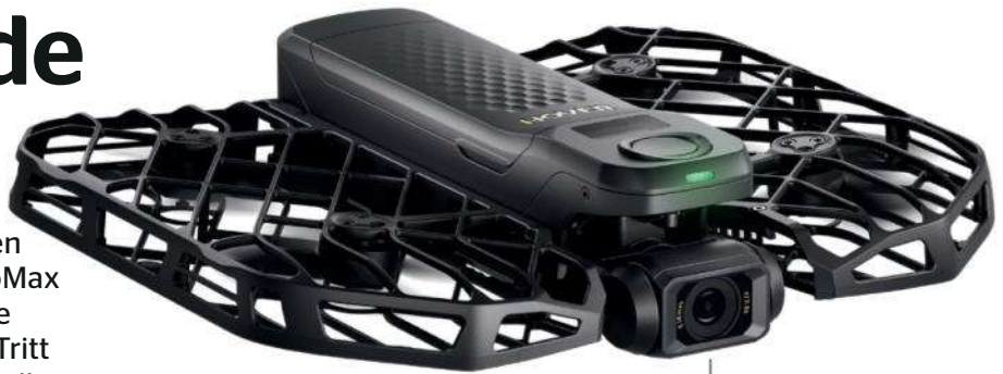
Ein Zwei-Wege-Gimbal stabilisiert die winzige 8K-Kamera.
