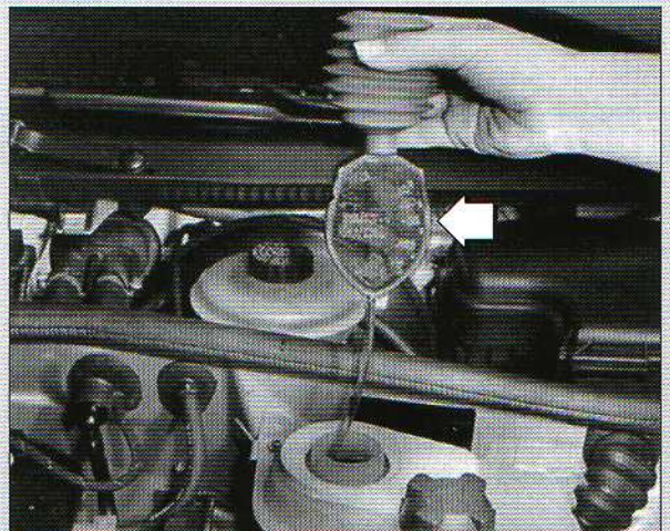
Hier wird mit einem Frostschutzprüfer (Pfeil) die Gefrier-schutzmittel-Konzentration geprüft.
