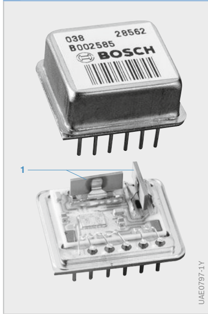
2 Piezoelektrischer Beschleunigungssensor (Zweikanaliger Sensor für Leiterplattenmontage)
