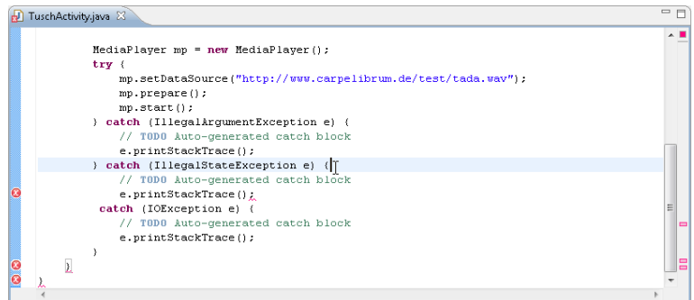
Abbildung 4.9: Hier wurde ein catch-Block nicht korrekt abgeschlossen.
