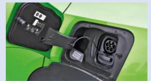
Der bordeigene Wechselstromlader schafft 7,4 bzw. 11 kW, an der Schnellladesäule sind bis zu 100 kW möglich
