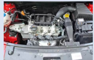
Bitte mitzählen: Die Benziner haben immer drei Zylinder; zum Einsatz kam auch eine Erdgasversion
