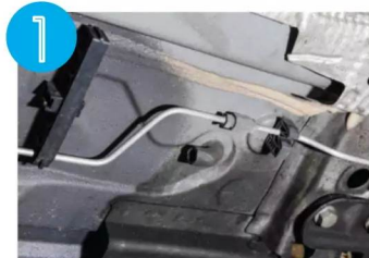
BREMSLEITUNGEN Frisst sich hier der Gammel fest, kann die Bremswirkung im schlimmsten Fall ausbleiben. Gefahr!
