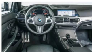
Das aktuelle Cockpit mit großem Bildschirm und iDrive mit Dreh-Drück-Regler
