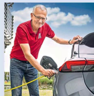
Mit maximal 100 kW dauert das Aufladen des Akkus auf 80 Prozent am Schnelllader ungefähr 30 Minuten
