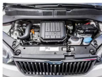
Die 75-PS-Maschine beschleunigt den Citigo in 13,2 s von 0 auf 100 km/h
