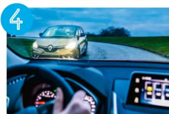
BELEUCHTUNG Übel, wenn das Abblendlicht den Gegenverkehr blendet. Der TÜV achtet auch auf die richtige Einstellung
