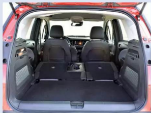
Cleveres Konzept im Crossland X: Per flexibler Rückbank und Durchlade wird der kleine Opel zum Van
