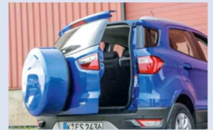
Bequem zu schließen, aber unpraktisch in engen Lücken: die seitlich öffnende Heckklappe des EcoSport
