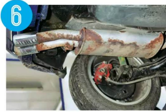
AUSPUFF Wer häufig Kurzstrecke fährt, riskiert einen löchrigen Endschalldämpfer. Ersatz kostet aber nicht die Welt
