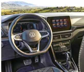
Facelift-Cockpit (ab 2023) mit größerem Zentralsdisplay, aber nun ohne Drehregler
