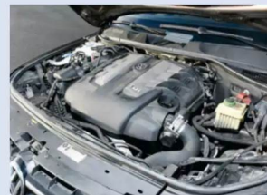
Ölverlust und gelängte Ketten sind im gehobenen Alter TDI-Themen
