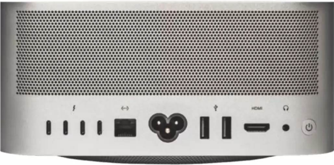
Auf der Rückseite gibt es unter den Luftauslässen zwei USB-A-Ports, viermal Thunderbolt 5, Gigabit-Ethernet, HDMI und eine hochohmige Klinkenbuchse.
