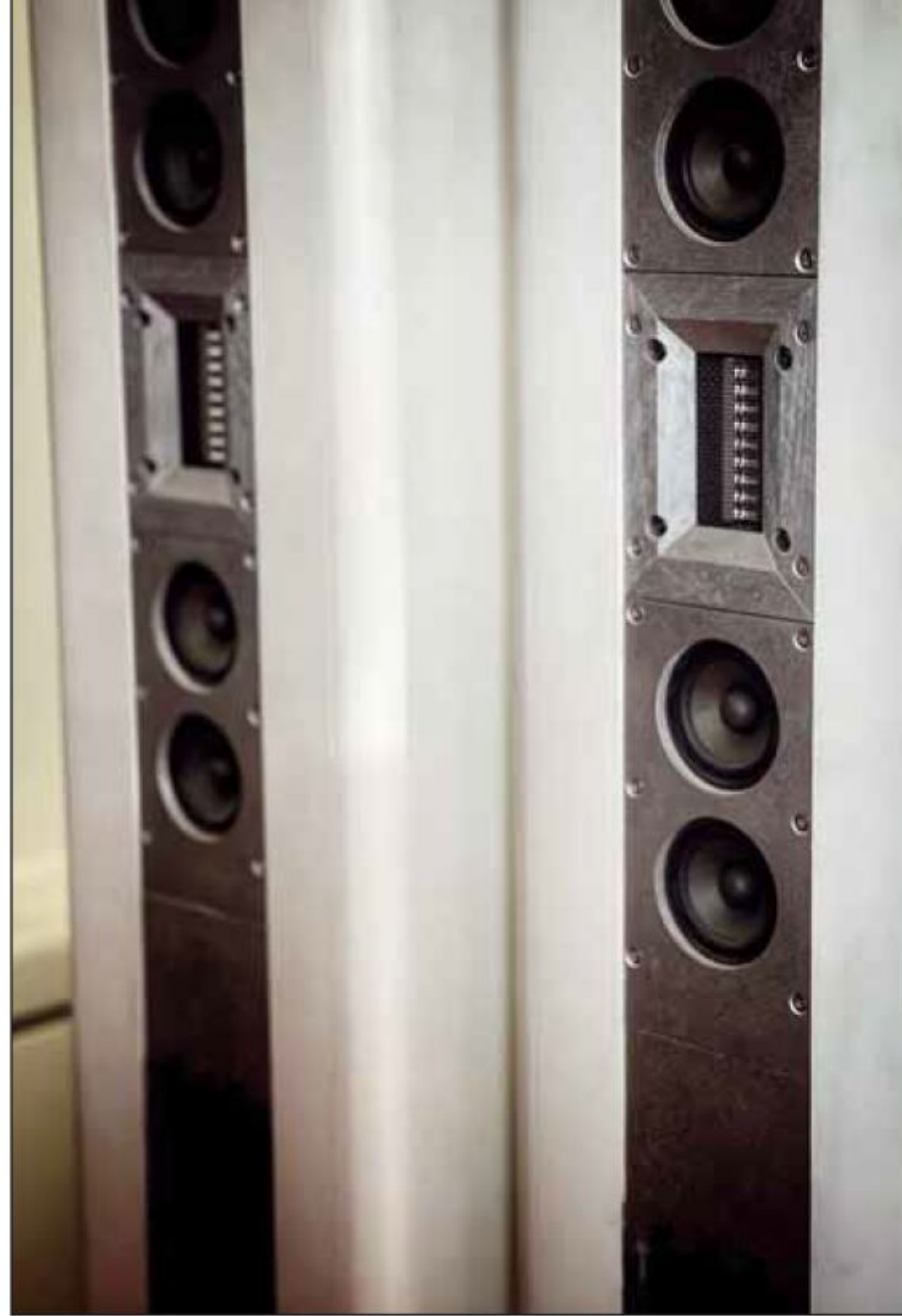
„LaDiva“ arbeitet mit einem AMT im Hochtton, FR55X als Mitteltöner und BOSE-901-Bässen
