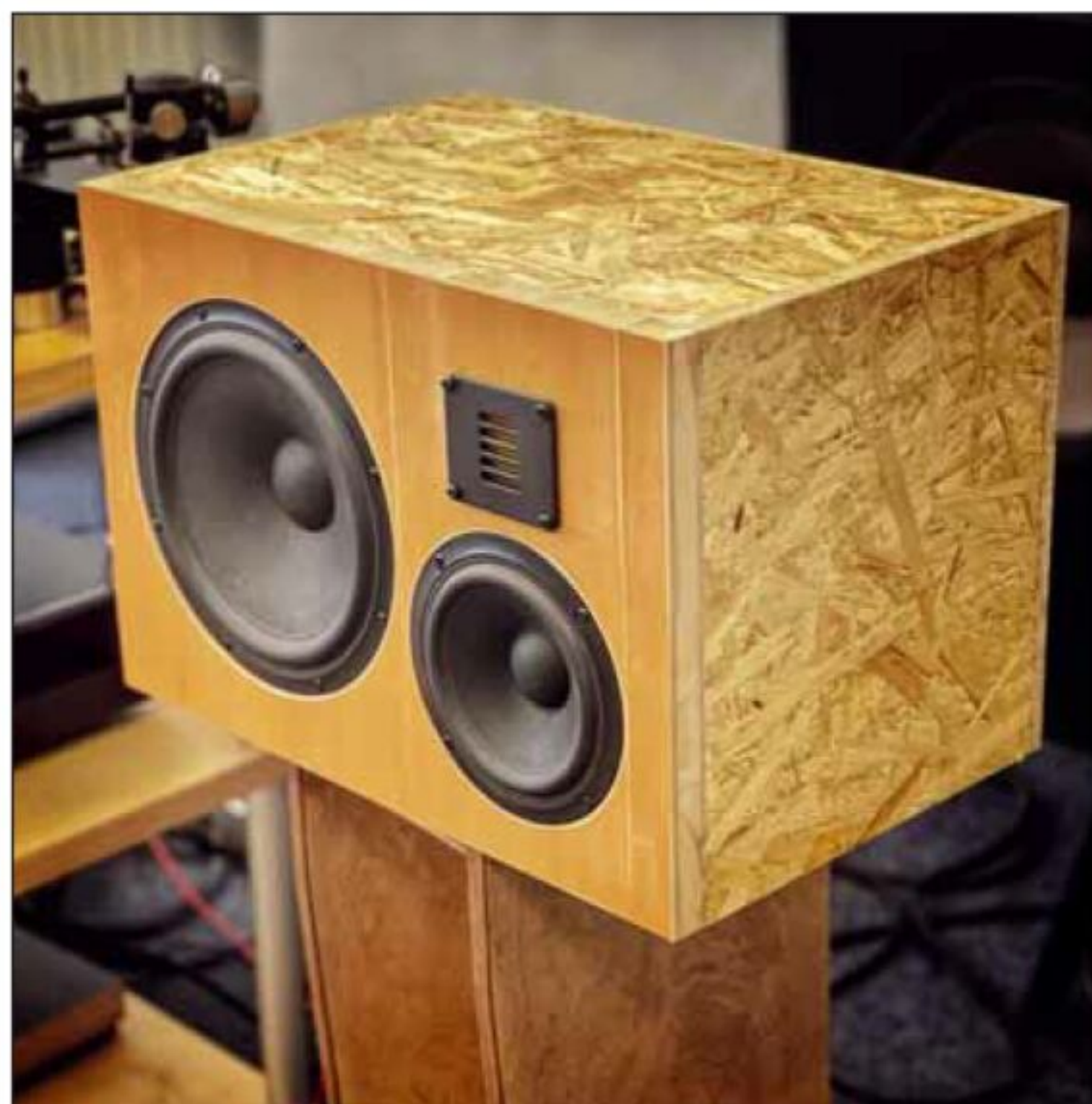
Die rustikale „Drei“ arbeitet vollaktiv mit einem Arylic-DSP-Amp
