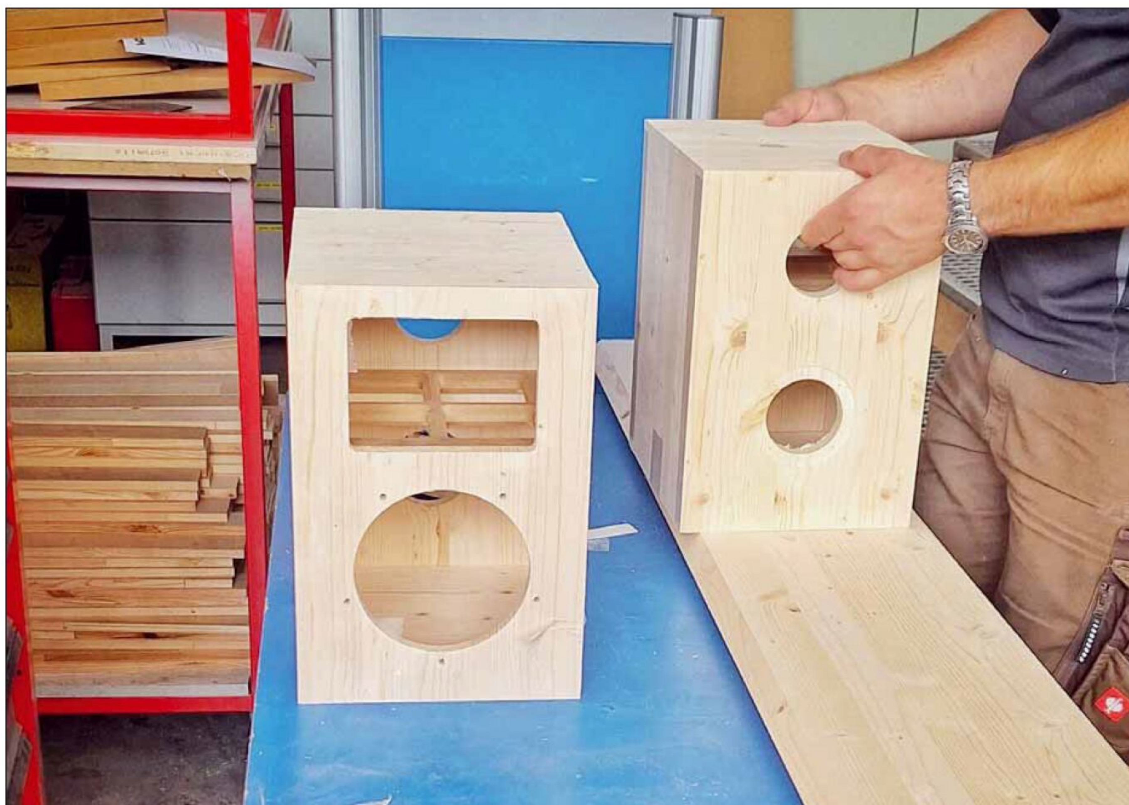
Auch die Echtholz-Version hat eine innere Schallwand, auf den die fascettierte Front aufgesetzt wird.
