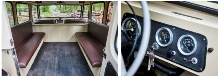
Der Trekka Stationwagon bieten Platz für bis zu acht Passagiere, wobei von den hinteren sechs erwartet wird, dass sie sich aneinander festhalten. Dafür ist aber der Zustieg sehr komfortabel. Ost-West-Mix: Ein Teil der Instrumente ist von Skoda, unter anderem auch der Tacho mit Mellen-Anzeige. Mittig finden sich britische Zusatz-Uhren von Smiths
