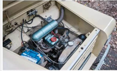
Knorriges Motörchen , weit weg vom ursprünglichen Einsatzort: Der 1,2 Liter-Vierzylinder befeuert ursprünglich die ab 1959 gefertigte Octavia-Familie. Der Trekka ist aber zumindest nicht schwerer als seine Pkw-Verwandten
