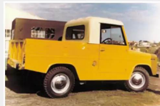
Basis-Variante: Zunächst wird der Trekka ausschließlich mit Hardtop-Kabine angeboten, für die Ladefläche wird ein Planen-Aufbau mitgeliefert. Einziges Zubehör ist anfangs eine Anhängerkupplung
