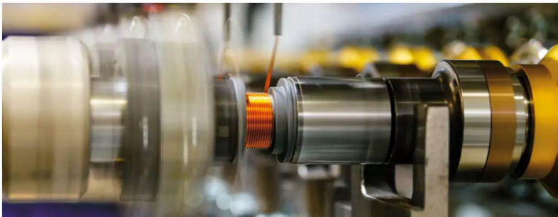
Aumann-Maschine im Einsatz: Produktion von Elektroschulspulen für E-Motoren
