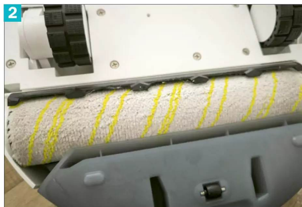
1 (1) Beim Roboter von Nedis muss man sich entscheiden, ob er wischen oder saugen soll. Dementsprechend muss der Wisch- (l.) oder Saugersatz (r.) installiert werden (2) Der reine Wischroboter RCF 3 von Kärcher macht dank eingebauter Wischrolle einen guten Job. Das Schmutzwasser wird übrigens wieder aufgefangen
