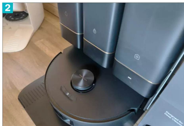
1 (1) Bei vielen modernen Saugrobotern geht es mittlerweile fast staubfrei zu: Eine Absaugstation befördert den Dreck automatisch in einen klassischen Staubbeutel (2) Dreikammersystem von Mova: Frisch- und Schmutzwassertank sowie die Absaugstation mit ein-gesetztem Staubsaugerbeutel (v. l. n. r.)
