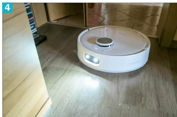
3 (3) Einige Geräte werden mit einer Absaugstation ausgestattet. Diese saugt den Roboter aus und befördert den Dreck in einen Staubbbeutel (4) Orientierung im Dunkeln: Die eingebauten LEDs erlauben dem Saugroboter (im Bild: Switchbot S10) eine bessere Orientierung und Koordination
