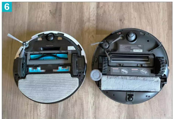
5 (5) Coole Sache: Der Mova V50 kann seine Rollen ausfahren und so problemlos auch kleine Stufen in der Wohnung, wie hier ins Badezimmer, überwinden (6) Zwei Systeme im Vergleich: Links der klassische Wischmopp, der im Betrieb „nur“ vibriert. Rechts ein Rollensystem mit zusätzlichem kleinen Kantenmopp links
