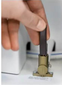
Ablassventil für die Wasserleitungen öffnen. Oft liegt es beim ...
