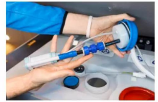
Tauchpumpe aus dem Tank ziehen und Wasserreste herausschütteln.
