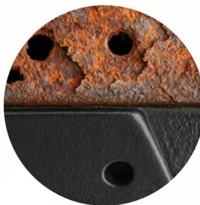
Fahrzeug auf der Hebebühne der Rostschutzklinik (l.). Vorher-nachher-Vergleich einer Rostbehandlung (o.).
