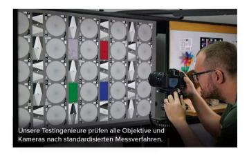
die Aufnahmen zu den Rändern hin abdunkeln - ie höher der Wert in Blendenstufen, desto dunkler wird es. Die chromatische Aberration gibt zusätzlich und dies in Pixeln - Aufschluss über die Breite von Farbsäumen.
