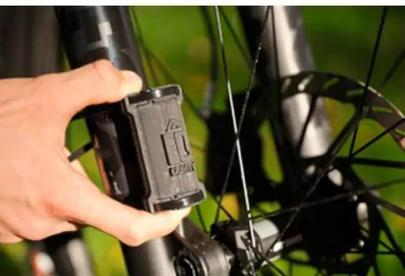
**Festgezurr** Der Bikemetrics EQLZR-Gravity wird mithilfe von Kabelbindern und optionalen Klebepads unten am Gabel-Casting befestigt.
