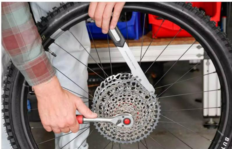
Mit Kettenpeitsche und Abzieher lässt sich die Kassette am Hinterrad lösen.
