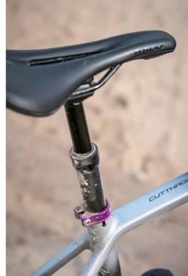
**Variostütze an Bord:** Auch für Gravelbikes gibt es sie. Per linkem Hebel kann man den Sattel von 50 bis zu 125 mm absenken.
