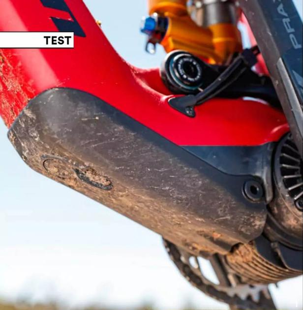
1 | Robust und clever – der Akku wird über einen Deckel am Unterrohr entnommen, darin befindet sich ein Minitool.
