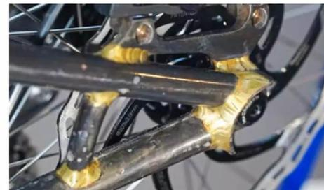
**Jedes Detail am Rahmen** ist eine Augenweide. Die goldenen Hartlöttrauben schimmern unter transparentem Lack. Teile der Umlenkhebel stammen von Levins altem Santa Cruz.
