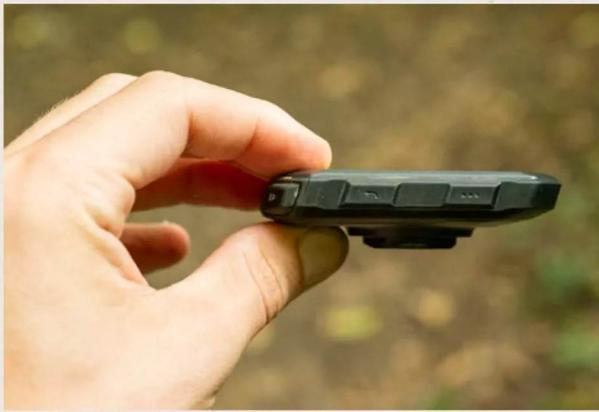
**Knopfleiste:** Statt eines Touchscreens verbaut Garmin für die Steuerung des Edge MTB klassische Tasten. Bei der Bedienung mit Handschuhen ist dies zuverlässiger.
