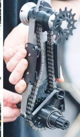
**Irrer Aufwand für eine cleane Optik:** Der Primär-Antrieb ist in einer Box versteckt.
