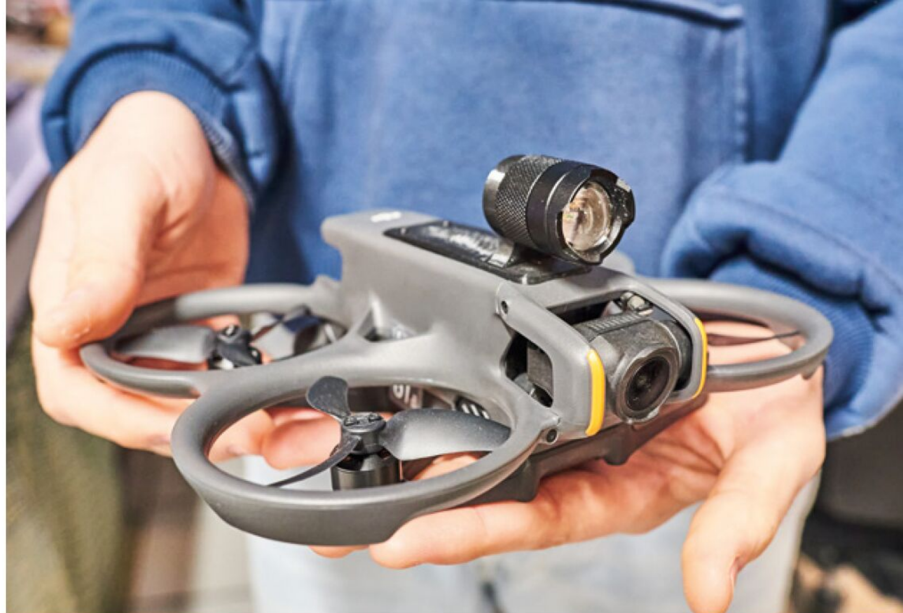
Diese DJI Avata ist mit einem Infrarotstrahler und einer modifizierten Kamera ausgestattet. Zusammen mit einer speziellen Videobrille sind damit Flüge in kompletter Dunkelheit möglich
