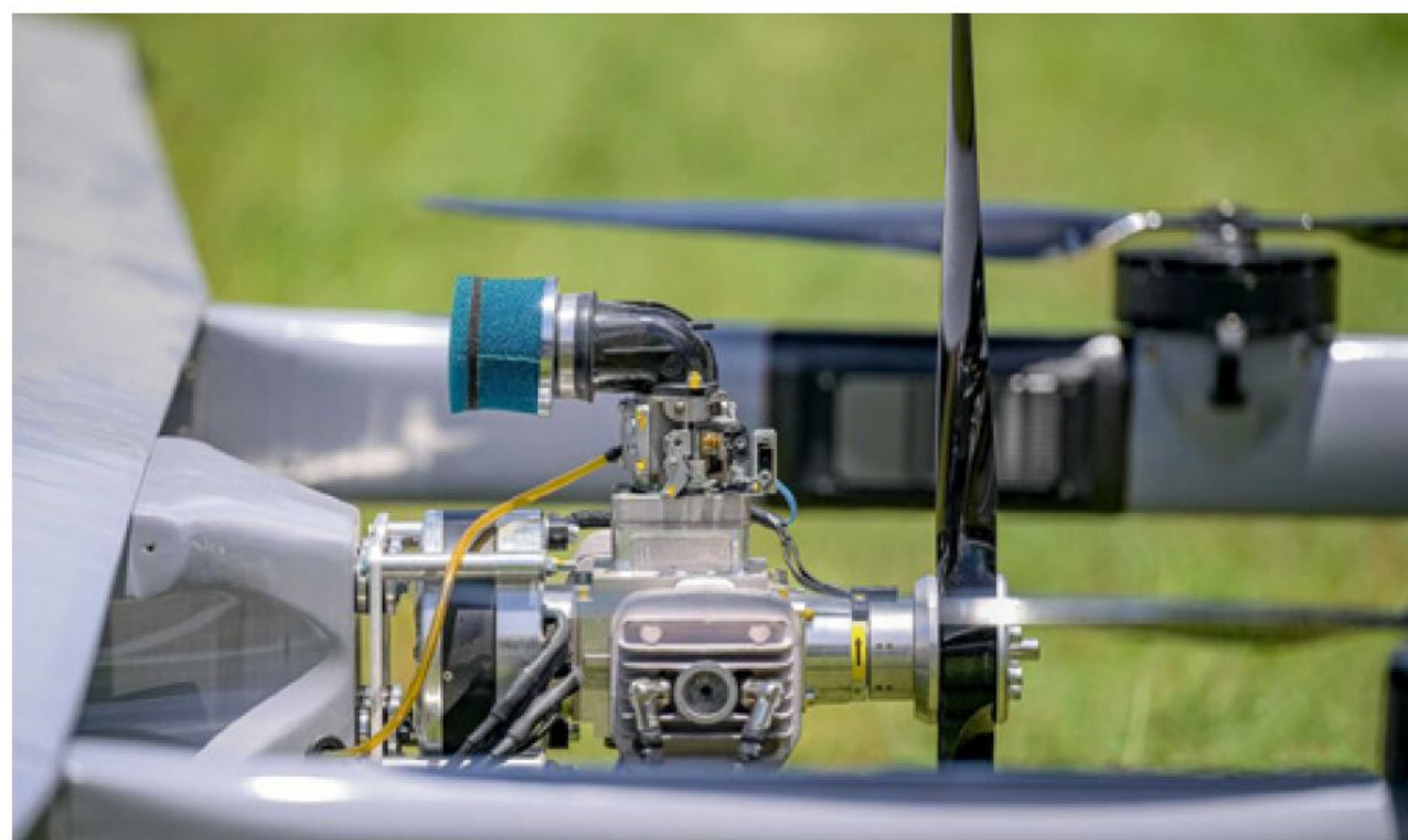
Mit Hilfe eines Zweitaktmotors von Sky Power International konnte die Reichweite der VTOL-Drohne deutlich gesteigert werden
