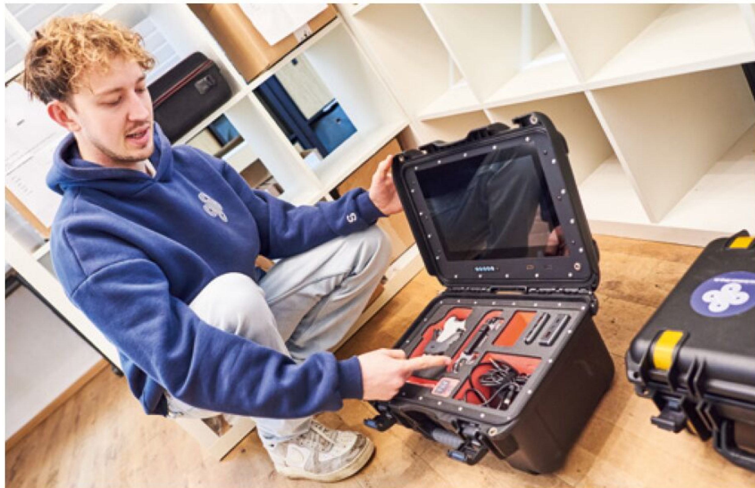
Eine Eigenentwicklung ist dieser Einsatzkoffer mit integriertem Monitor samt Stromversorgung und Platz für Drohne und Zubehör
