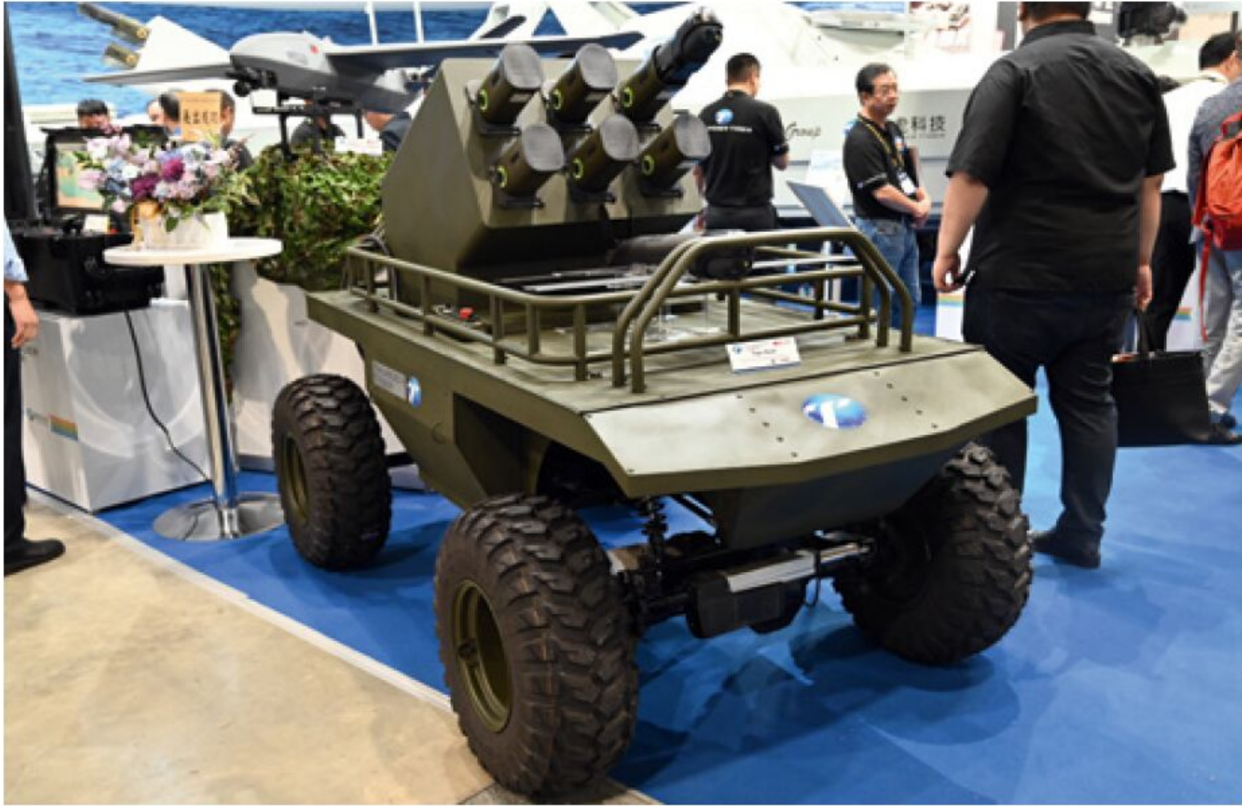
Thunder Tiger stellte auf der TADTE das unbemannte Bodenfahrzeug Tiger Road vor, das für Einsätze in Küstengebieten konzipiert wurde, um den Einsatz von Bodentruppen zu unterstützen
