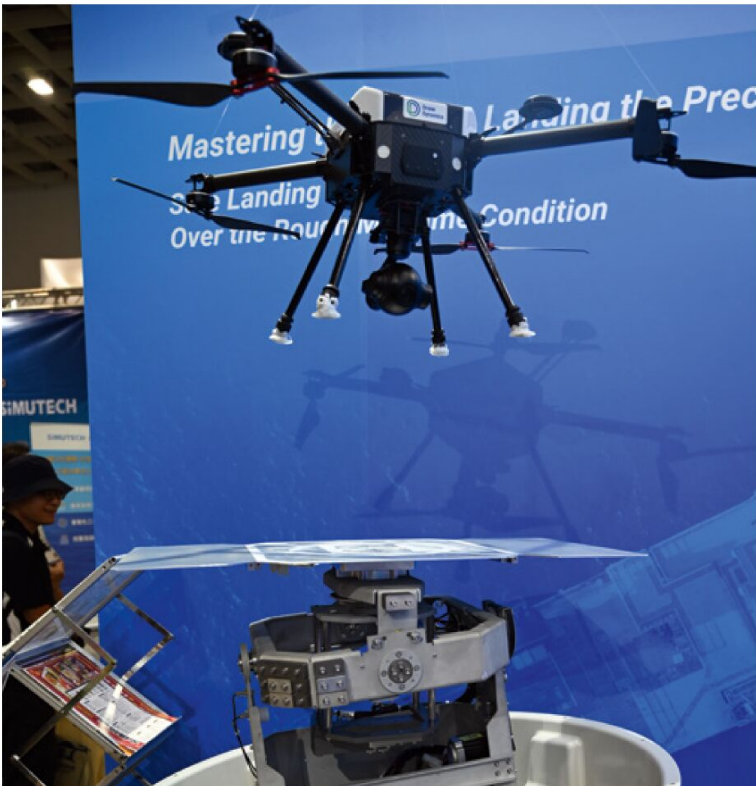
Pyras Technology stellte eine Landeplattform für Drohnen vor. Auf Schiffen oder Booten montiert, gleicht diese aktiv den Wellengang aus, sodass beispielsweise ein Multikopter zu jedem Zeitpunkt eine ebene Fläche zur Landung hat
