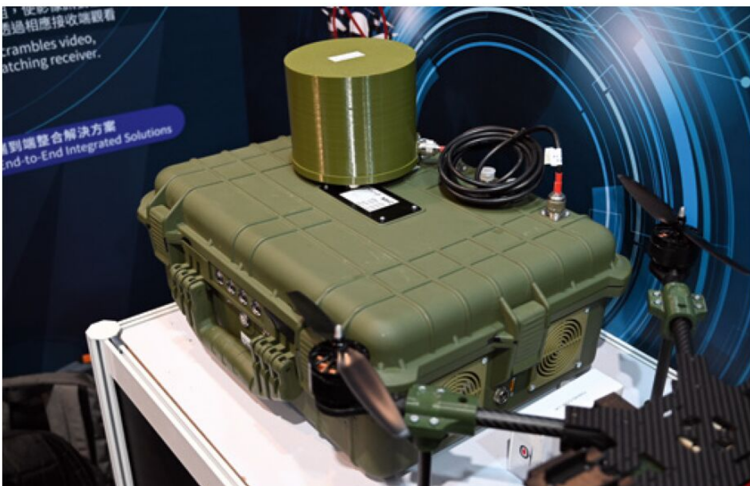
Tykho Electronics aus der Ukraine hatte den Prototyp für eine transportable Jamming-Lösung dabei. Damit soll es möglich sein, eine Art temporäres Schutzschild zu errichten, um sich gegen feindlichen Kamikaze-Drohnen zu verteidigen
