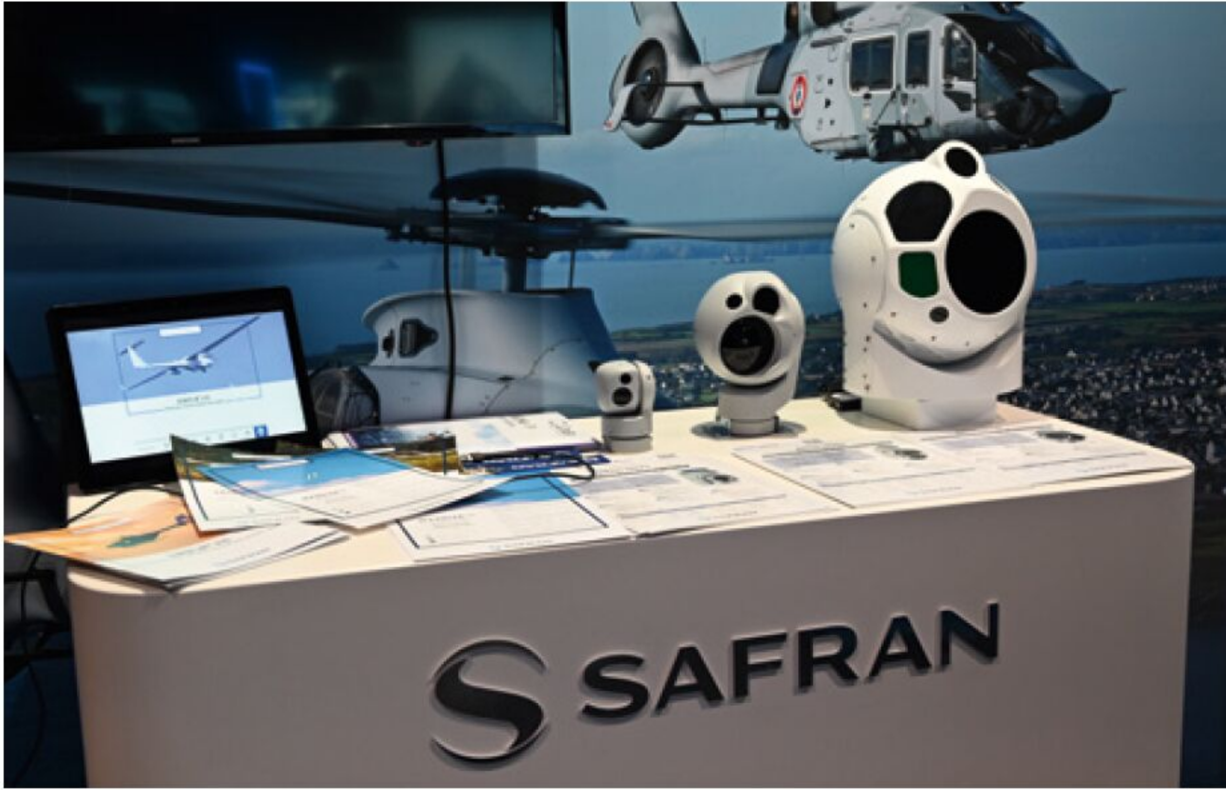
Die elektro-optischen ARTIS-Sensoren von Safran Electronics & Defense zur Luftaufklärung auf lange Distanzen
