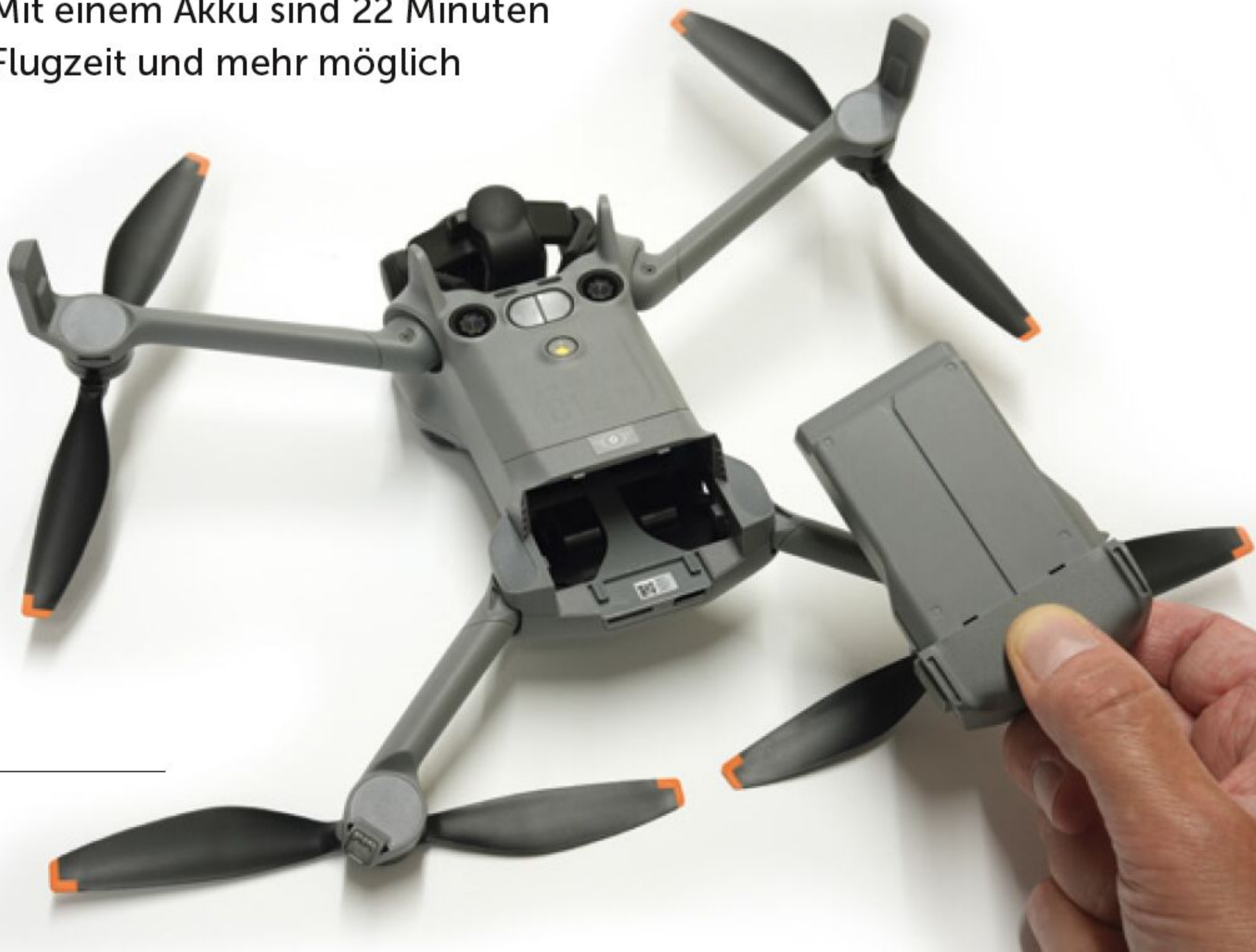
Drei Akkus plus Ladeschale gehören zur Fly More Combo und ermöglichen zusammen deutlich über 1 Stunde Flugzeit
