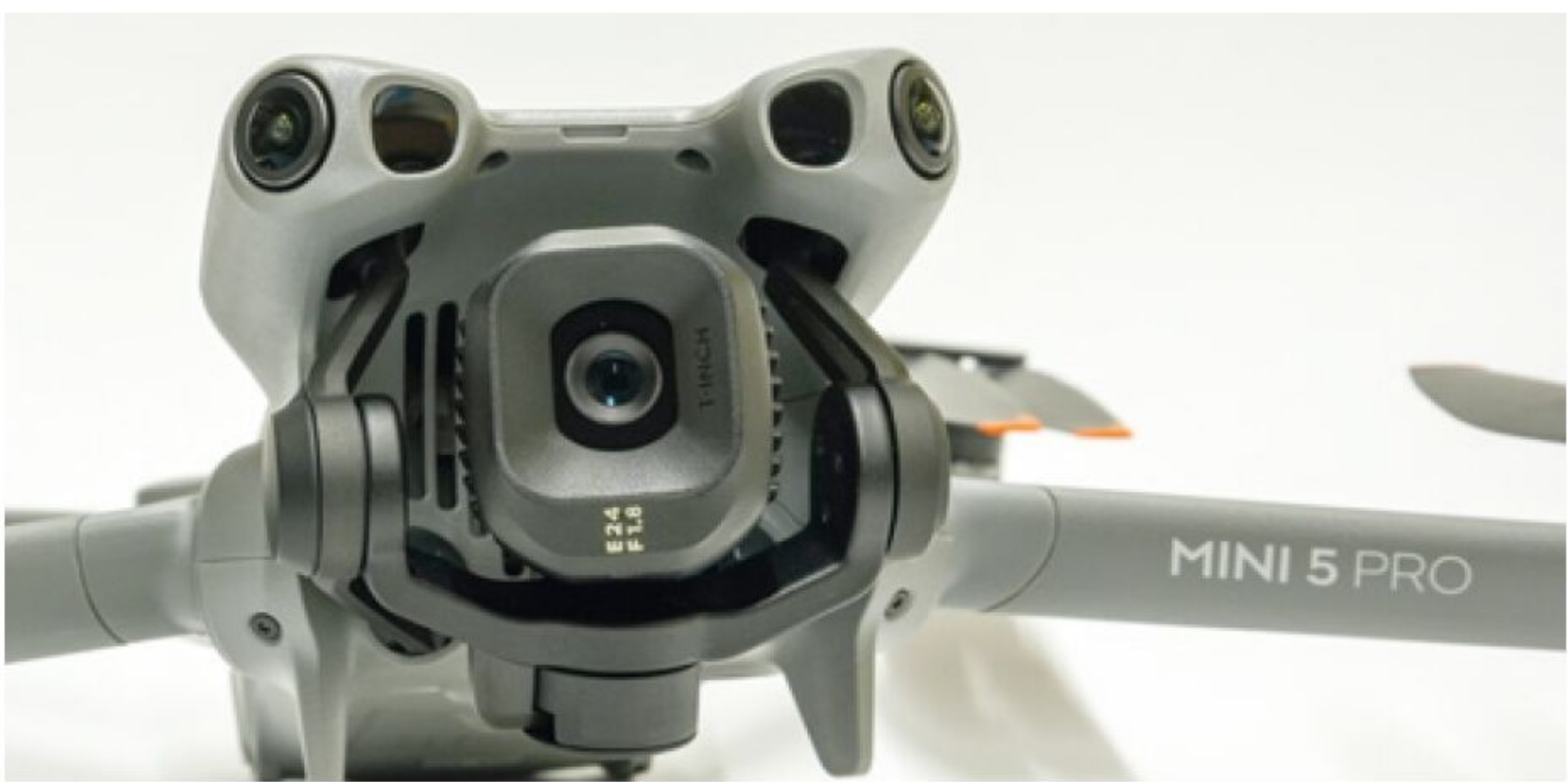
Highlights der Mini 5 Pro sind der neue 1-Zoll-Kamerasensor und die LiDAR-Sensorik zur Hinderniserkennung
