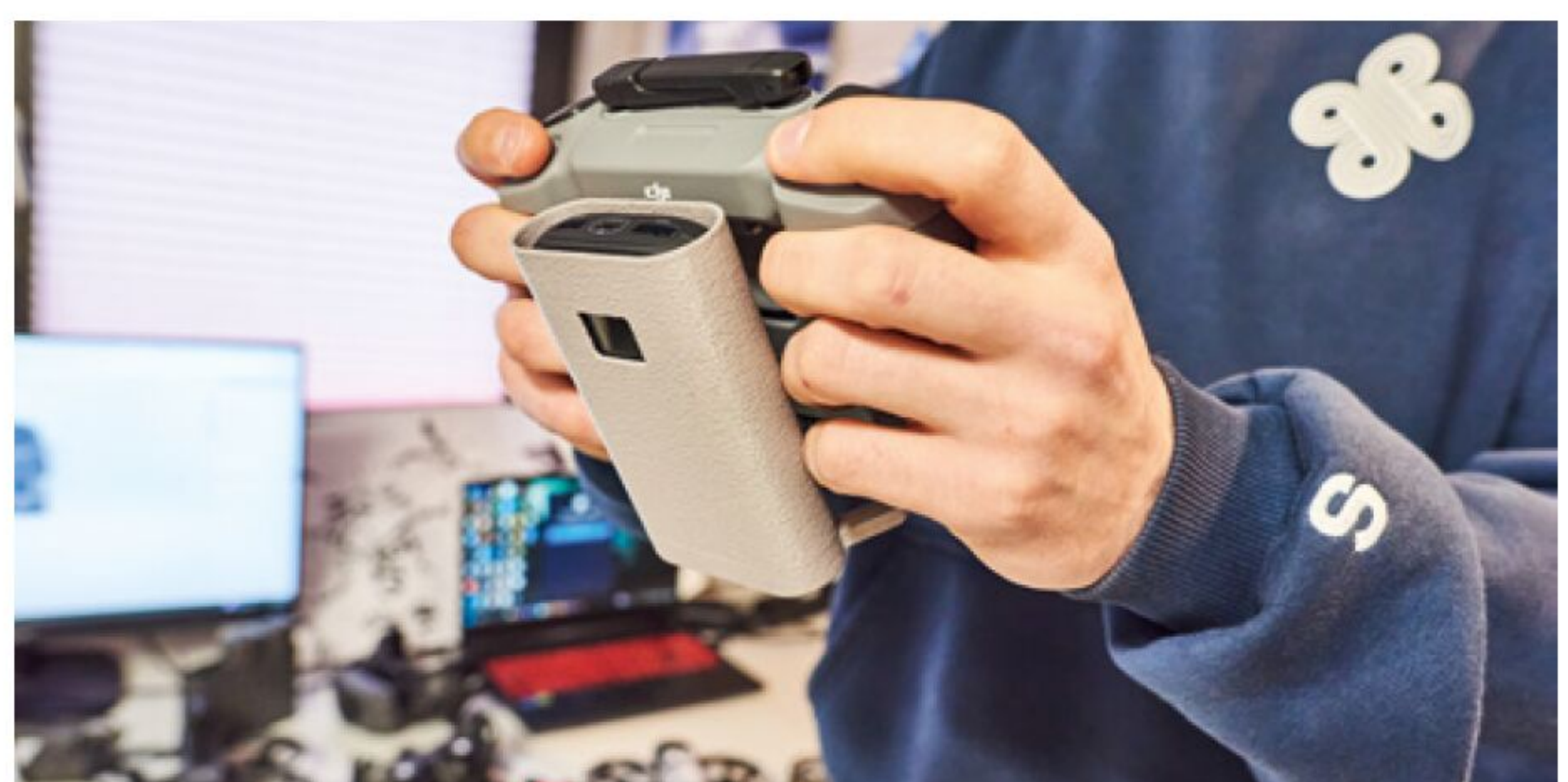
Der 3D-gedruckte Halter beherbergt eine Powerbank, mit der sich die Betriebszeit der Fernsteuerung von rund 3 Stunden auf über 9 Stunden erweitern lässt. Eine Entwicklung, die auf Basis von Kundenwünschen entstanden ist
