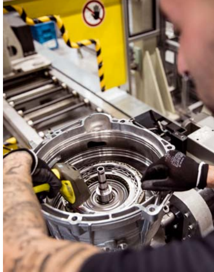
Montage eines Hybridgetriebes im ZF-Werk Saarbrücken. Ein Teil der Produktion des Standortes könnte nach Ungarn gehen
