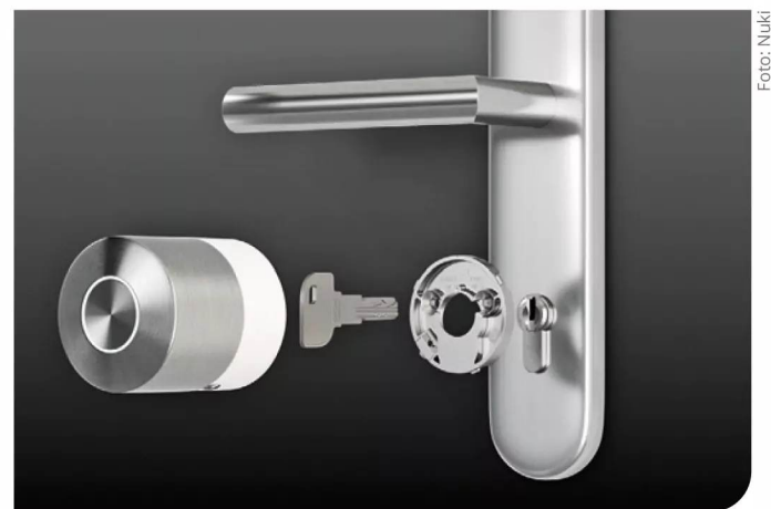
Das Prinzip von smarten „Schlüsseldrehern“: Man steckt einen Schlüssel von innen in den Schließzylinder. Darüber stülpt man das Antriebsgehäuse. Dieses dreht den Schlüssel in die gewünschte Richtung.
