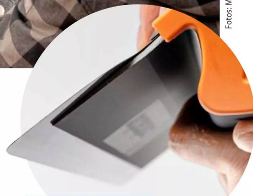
DAS EDELSTAHLBLATT IST 580 MM LANG, 0,3 MM DÜNN UND FLEXIBEL.
