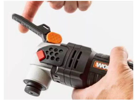
EINFACH, zubehörkompatibel, aber mit Schwächen im Kraftschluss – die „Hyperlock“-Kopfhebelverschraubung von Worx.
