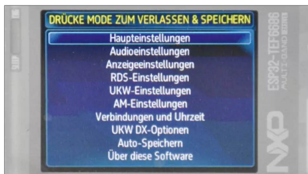
Die Hauptmenüoberfläche bietet viele Einstellmöglichkeiten. Ab Werk kommt der NXP ESP32-TEF6686 aber mit chinesischer Voreinstellung
