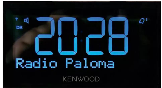
Im Betrieb wird die Uhrzeit weiterhin groß und deutlich angezeigt. Der Kanalname erscheint darunter, in derselben Zeile werden zudem die Menüeinträge dargestellt
