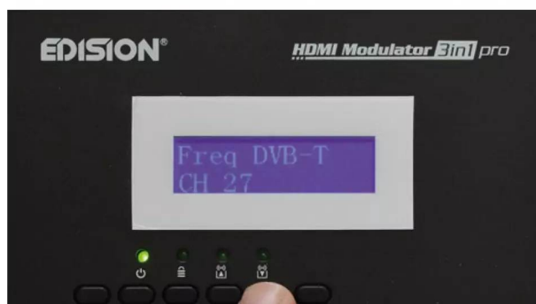
Um gegenseitige Störungen auszuschließen, ist der Modulator auf einen nicht vom ortsüblichen DVB-T2 oder DVB-C genutzten Kanal zu programmieren
