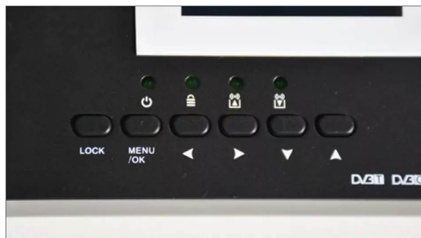
Über die sechs Tasten des Bedienfelds lässt sich der Modulator vollumfänglich programmieren und berücksichtigt auch zu vergebende Sendernamen
