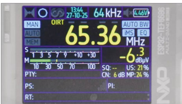
Für das OIRT-Ost-UKW-Band ist ein eigener Frequenzbereich programmiert worden, in dem das 30-KHz-Kanalraster berücksichtigt wird
