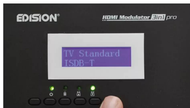
Zu Beginn der Programmerroutine des 3in1 pro ist festzulegen, welchen Übertragungsstandard er nutzen soll
