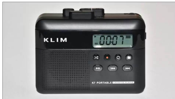
Der KLIM K7 ist ein kompakter Kassettenplayer, der nicht nur alte Tapes digitalisiert, sondern auch MP3- und WMA-Files wiedergeben kann
