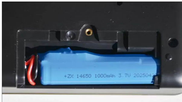
Hinter einer verschraubten Klappe an der Rückseite befindet sich der 1000 mAh große Lithium-Akku des Kassettenplayers
