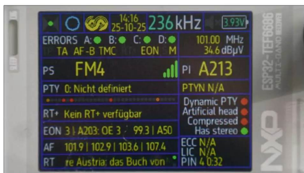
Zu den Highlights der TEF-Empfänger, wie dem NXP ESP32-TEF6686, zählt neben den sehr guten Empfangsleistungen die detaillierte RDS-Auswertung
