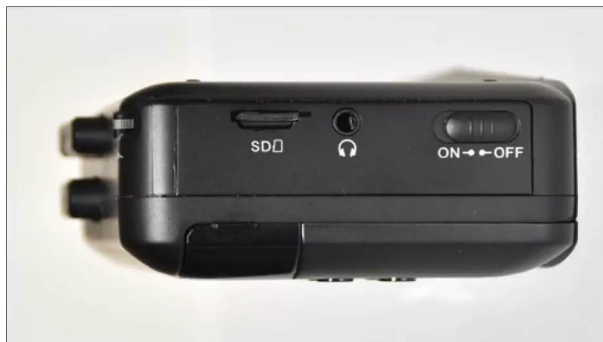
An der rechten Seite befindet sich der Schlitz für die Speicherkarte. Weiter sind hier die Kopfhörerbuchse und der Hauptschalter eingebaut
