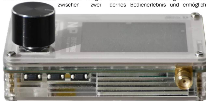
An der Oberseite des kleinen TEF-Empfängers befinden sich drei Drucktasten, sowie die SMA-Buchse für den Anschluss einer Antenne
