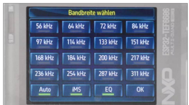
Für UKW bietet das Radio 16 Bandbreitenfilter. Sie können manuell oder automatisch an den Empfang angepasst werden
