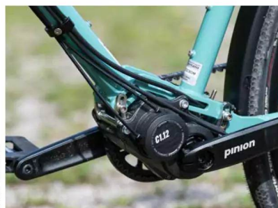
Pinions 12 Gang-Getriebe im Magnesiumgehäuse: 600 % Übersetzungsumfang, Entfaltung vom 1,49 bis 8,79 m.
