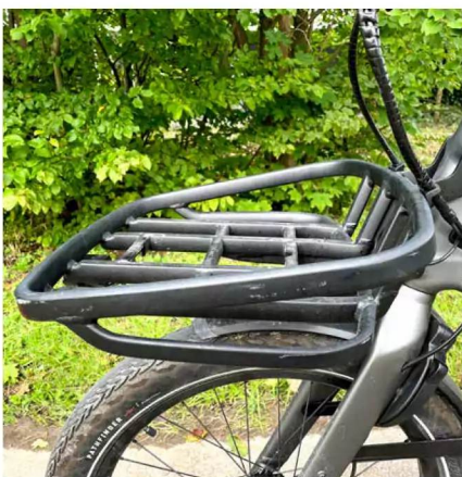
Da geht was drauf: Das vordere Rack trägt ganze 20 Kilogramm.
