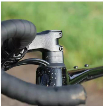
Die interne Kabelführung beginnt direkt unter dem Vorbau. Sie sorgt für eine sehr saubere Optik des Silex.
