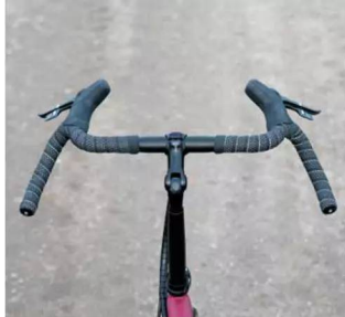
Stark nach außen gestellter Lenker für mehr Fahrstabilität.
