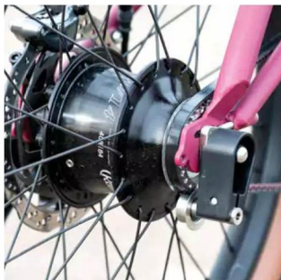
Rohloffs Speedhub-Nabe liefert eine breite 526-%-Übersetzung.
