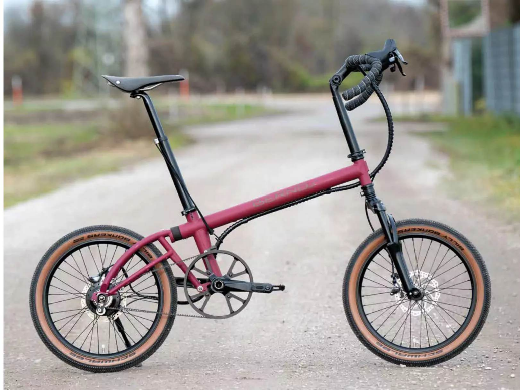
Stark nach außen gestellter Lenker für mehr Fahrstabilität.
