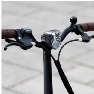
Die Cockpit-Front mit mittig platziertem USB-Scheinwerfer.
