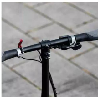
Roten Hebel drücken, Hinterrad einschwenken; das IVE steht!
