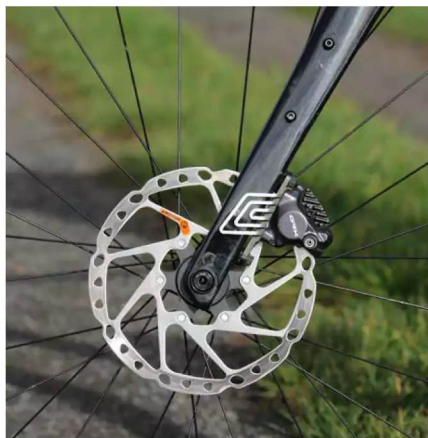
Vorn wie hinten 180er-Bremsscheiben sind bei Gravelbikes nicht selbstverständlich. Sie sind ein tolles Sicherheits-Plus.
