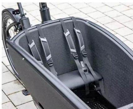
Blick in die EPP-Transportbox mit neuem Gurt-Magnetverschlusssystem von Fidlock.
