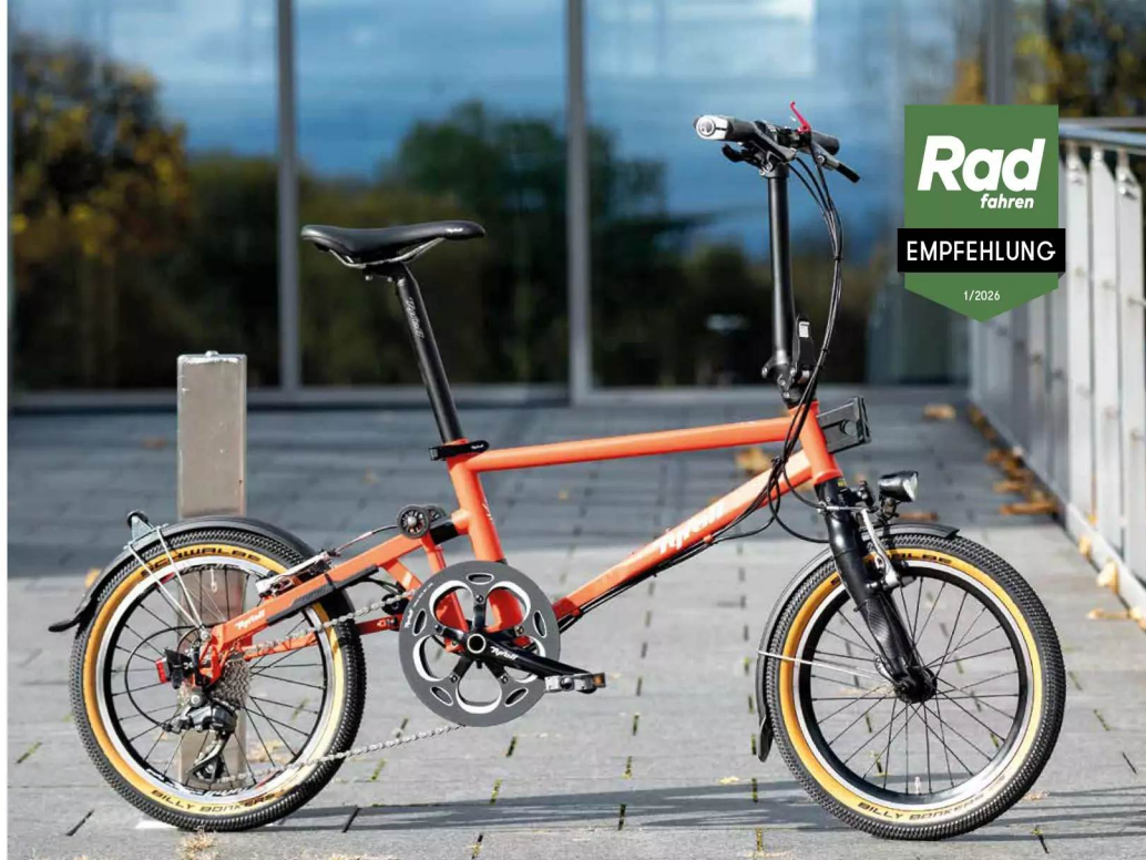
Roten Hebel drücken, Hinterrad einschwenken; das IVE steht!
