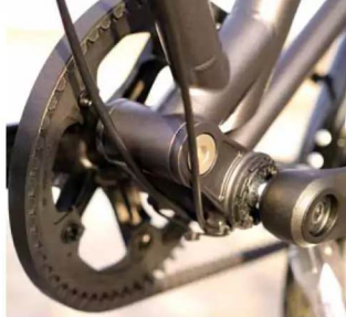
Rahmengelenk des Vello zum Abklappen des Hinterbaus.
