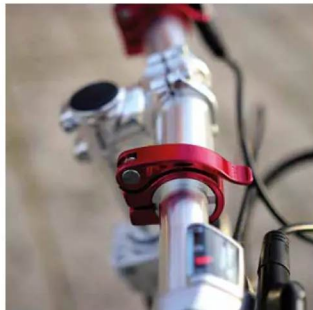
Schnellspanner zum Klemmen der beiden Lenkerenden.
