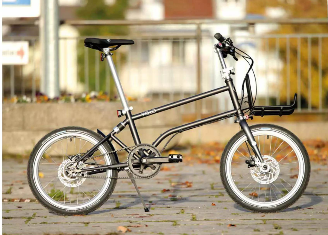
Rahmengelenk des Vello zum Abklappen des Hinterbaus.
