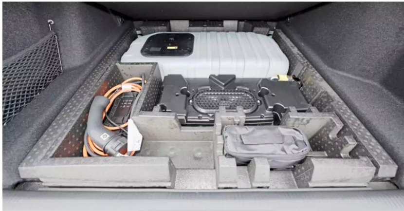
VERKLEINERT E-Technik und Batterie kosten beim PHEV Stauvolumen
