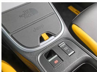
DIE KLAPPE mit den Firmenschriftzügen arretiert magnetisch
