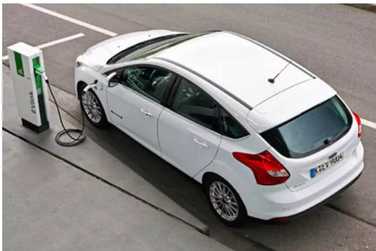
NISCHIG Von 2013 bis 2017 auch mit 107 kW starkem vollelektrischen Antrieb samt 23-kWh-Akku
