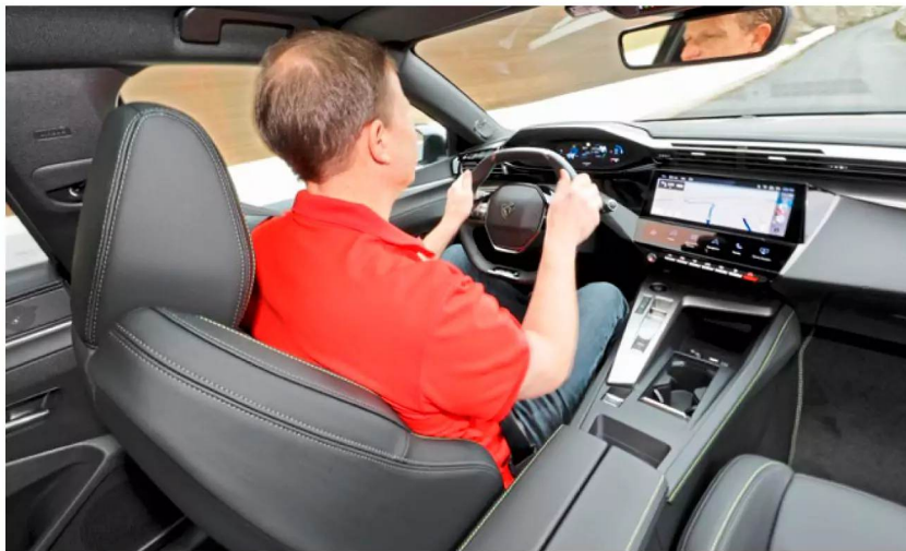
GESTIEGEN Neue digitale 3D-Instrumente und Lenkrad-Schaltwippen für die Rekuperation (PHEV und EV) zählen im Cockpit zu den wichtigen Neuerungen
