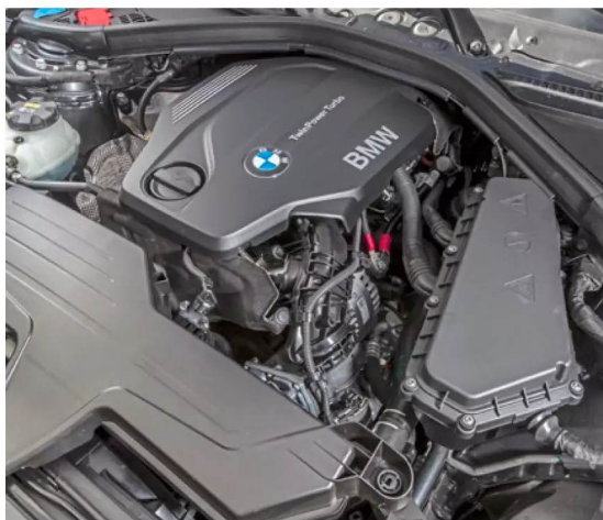
AUFPASSEN Bei den Vierzylinder-Dieselmotoren bis 2015 bereitet die Steuerkette meist Probleme
