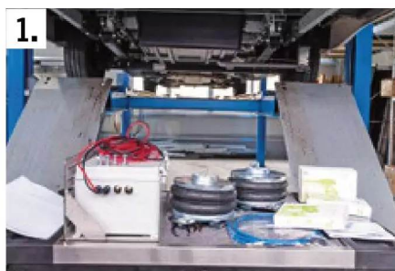
1. Nicht mehr und weniger muss installiert werden. Zwei Luftfedern und Kontrollbox mit Kompressor.
