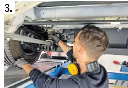
3. Ausgangssituation: Das Anschlagsgummi kann (im Idealfall) problemlos rausgeschraubt werden.
