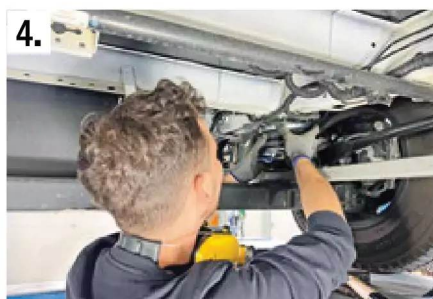
4. Die neue E-Trailer Luftfeder wird exakt im gleichen Gewinde verschraubt: Plug and play sozusagen.
