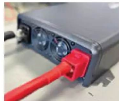
Gute Isolationskappen für die Batteriekabel. Unsinnig: Gewinde in den Anschlusspolen.
