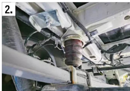
2. Ob eine Stahl- oder wie hier im Benimar werkseitig eine GfK-Blattfeder montiert ist, spielt keine Rolle.
