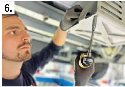
6. Die solide Edelstahl-Konsole für die Kontrollbox (Elektrik, Kompressor) wird am Rahmen verschraubt.
