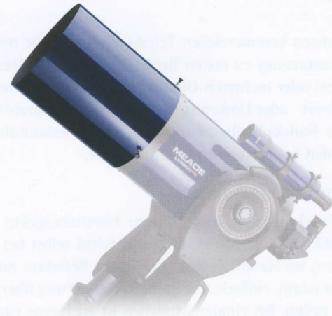
Abb. 1-19: Taukappe an einen Schmidt-Cassegrain-Teleskop.
