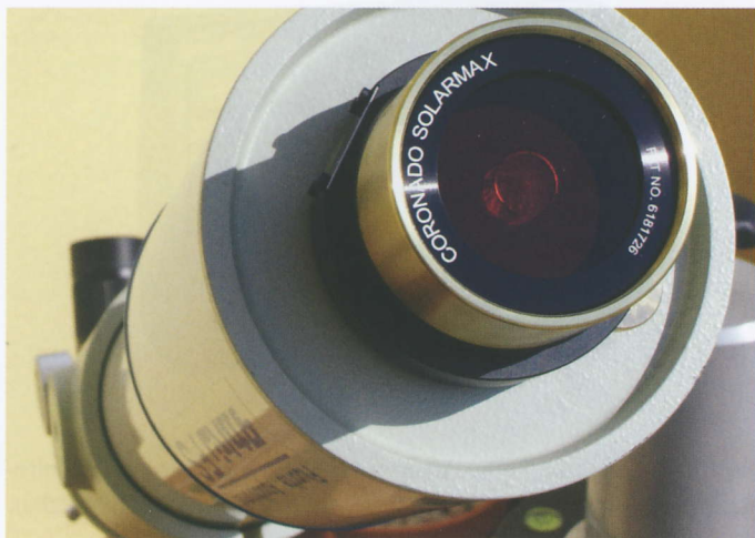
Abb. 1-41: Ein H-alpha-Filter wird auf die Teleskopöffnung aufgesteckt (oben). Es gibt auch komplette H-alpha-Teleskope mit festeingebautem Filtersystem (unten).
