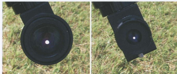
Abb. 2-3: Austrittspupille hinter dem Fernrohr – links langbrennweitiges Okular, rechts kurzbrennweitiges Okular.
