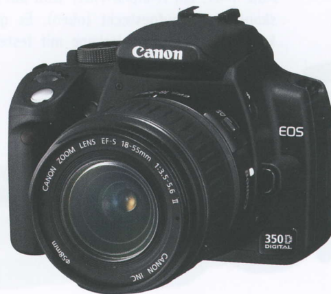
Abb. 1-42: Digitale Kompaktkameras (oben) sind kaum, Spiegelreflexkameras (unten) dagegen voll für die Astrofotografie einsetzbar.
