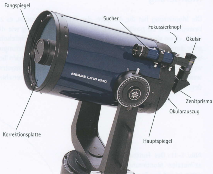
Abb. 1-10: Einzelteile eines Schmidt-Cassegrain-Tubus (oben). Der Beobachter blickt am hinteren Ende in das Okular.
