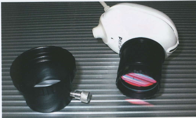
Abb. 3-23: Eine Webcam mit Adapter für die Okularprojektion (links), Ausrüstung des Webcam-Astronomen mit Teleskop, Webcam mit Adapter, Notebook und Batterie (rechts).
