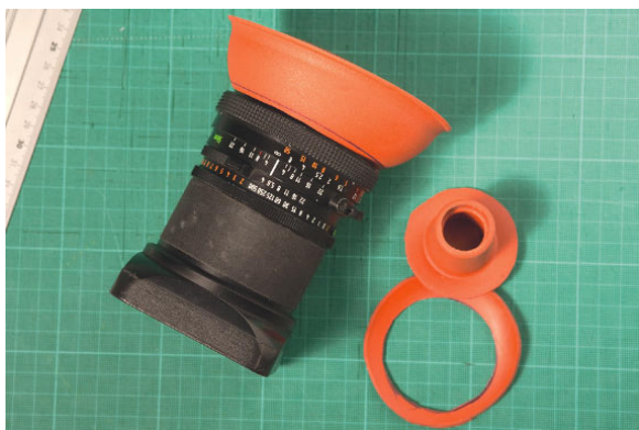
Das 4,0/50mm Mittelformatobjektiv mit dem Tilt-Adapter
