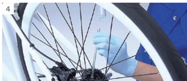
Wenn alles Öl aus der Spritze herausgedrückt ist, diese vom Schlauch abnehmen. So läuft das restliche Öl aus dem Schlauch in die Nabe.
