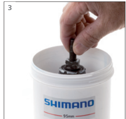
Die interne Einheit ca. 90 Sekunden so eingetaucht lassen.
