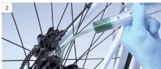
Den Entlüftungsnippel mit Schlauch befestigen und die Spritze aufstecken. Den Kolben langsam herunterdrücken, um das neue Öl in die Nabe zu füllen.
