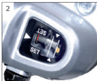
Die rote Markierung der Schubstange muss in einer Linie mit dem Ende der Achse stehen.
