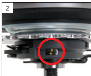
Die Ausrichtung der Markierungen im Fenster des Cassette Joints (Schalteinheit) überprüfen.
