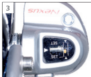
Ist die rote Markierung nicht sichtbar, muss geprüft werden, ob sich die gelbe Markierung zwischen den beiden weißen Linien befindet.
