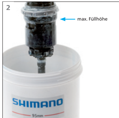
Bei Naben mit Rücktrittbremse muss zuerst die Bremsschuheneinheit entfernt werden. Die Nabe mit der linken Seite voran in das Öl eintauchen, bis das Öl die Oberkante der Hohlradeinheit erreicht.
