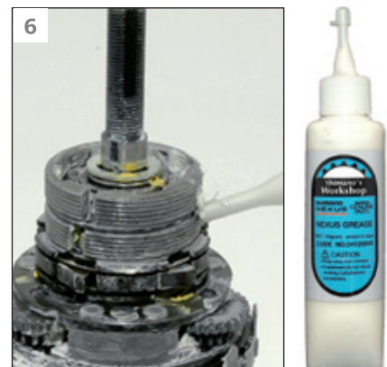
Die Bremsschuhe wieder einbauen und mit NEXUS Fett einfetten (Teilenummer: Y-041 20800).
