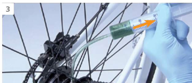
Um den Druck im Inneren der Nabe zu verringern, den Kolben in regelmäßigen Abständen etwas herausziehen.
