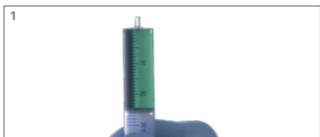
Die Spritze mit 25 ml SG-S700 Öl füllen.
