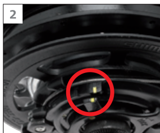
Die Ausrichtung der Markierungen am Cassette Joint (Schalteinheit) überprüfen.
