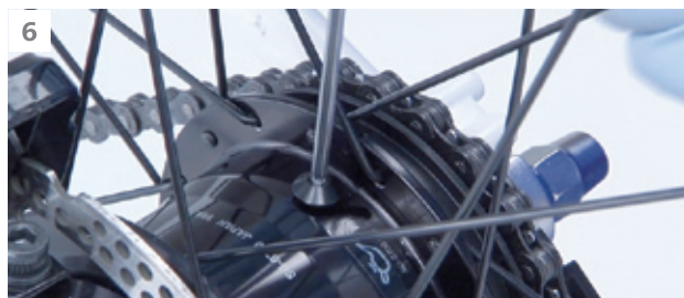
Die Schraube der Öloffnung mit einem 3-mm-Innensechskantschlüssel wieder eindrehen. Anzugsdrehmoment: 2-3 Nm.
