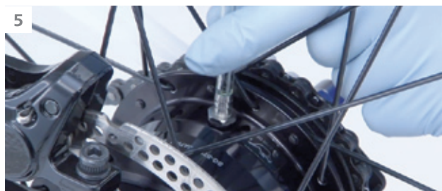
Den Entlüftungsnippel mit dem O-Ring und Schlauch abnehmen.
