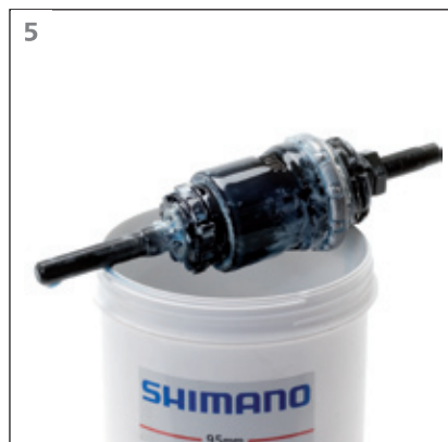
Das überschüssige Öl ca. 60 Sekunden abtropfen lassen.
