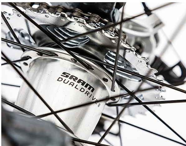
Beispiel: SRAM Dualdrive an Hinterradnabe
