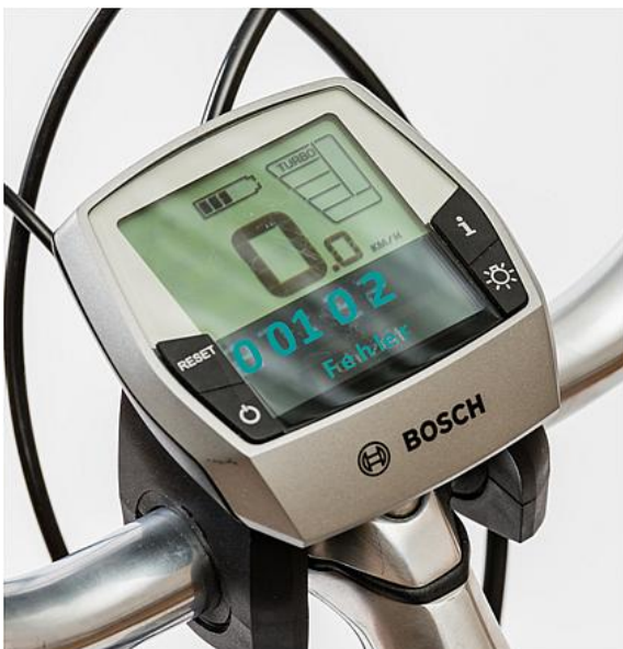
Beispiel: Fehler „Geschwindigkeitssensor“
