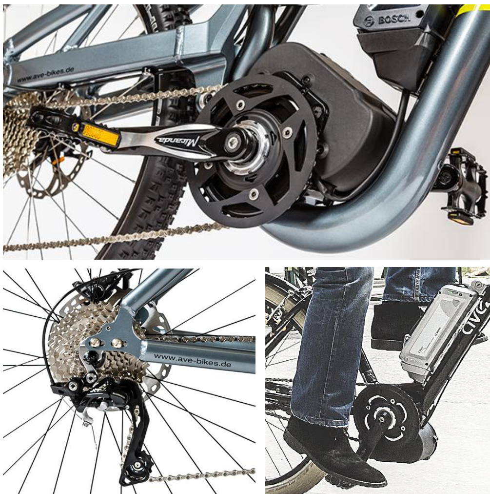
Beispiel: Ritzel, Zahnkranzpaket, Schaltwerk, Kette, Kettenblatt, Kurbel, Pedale
