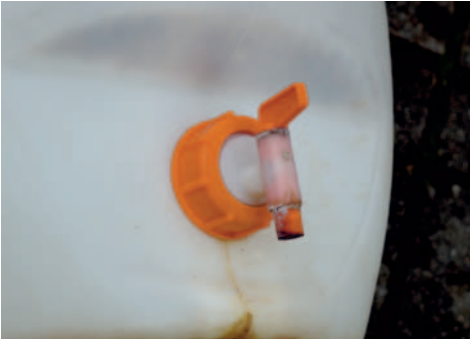
Verunreinigter Ablaufhahn am Kunststofffass.
