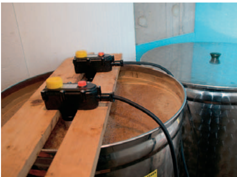
Das ist eine Möglichkeit, den Tauchsieder am Edelstahlfass zu befestigen.
