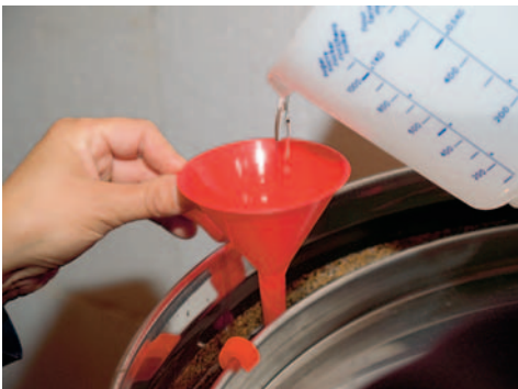
Füllen Sie das Öl am besten mit einem Messbecher und einem Trichter ein.
