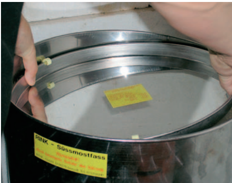
Setzen Sie den Schwimmdeckel zuerst leicht schräg auf den Apfelsaft.
