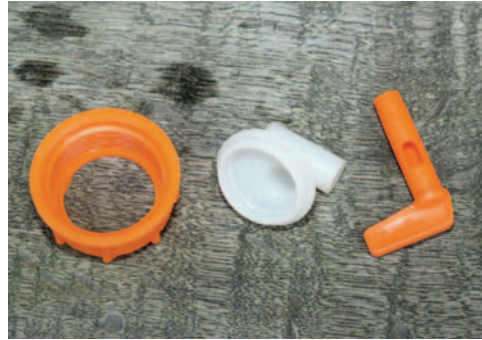
Zum Reinigen wird der Ablaufhahn in seine Einzelteile zerlegt.
