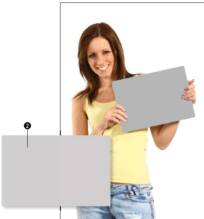
**3** Für eine genaue Messung wird eine sogenannte Graukarte **2** aus dem Foto-Fachhandel eingesetzt.
