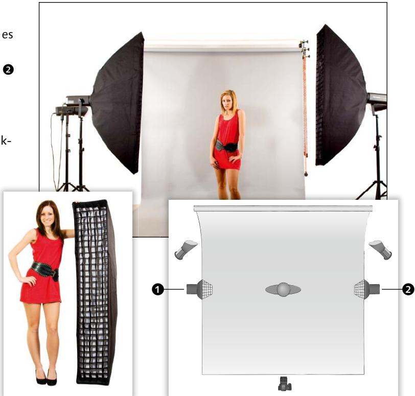
**2** Das Hauptlicht sollte etwa 1,5 bis 2 m Abstand zum Model haben und in einer leicht erhöhten Position stehen.
