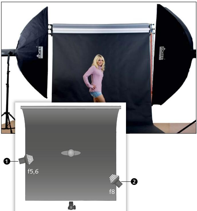
**2** Sie können nun die Lichtstärke der einzelnen Lichtquellen einmessen. Die Zielwerte für das Haupt- und Aufhelllicht können Sie der Skizze in Schritt 1 entnehmen.
