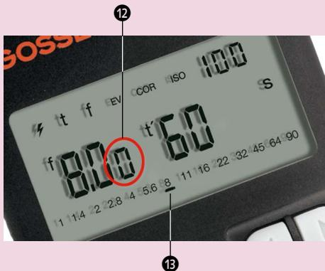
8,05. Die kleine 5 zeigt an, dass der Messwert zwischen den ganzen Blenden 8 und 11 liegt. Da es sich um eine 1/10-Anzeige handelt, liegt der Wert also genau in der Mitte zwischen diesen beiden Blenden. Würden Sie mit einer Kamera fotografieren, die mit halben Blendenstufen arbeitet, hätten Sie einen exakten Messwert; nämlich Blende f9,5!
