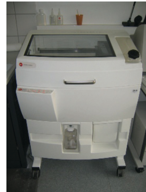
3D-Drucker der Fa. ZCorp, der weiße Gipsmodelle herstellt
