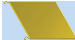
Klappe mit Haken Werkstoff: Aluminium 6061 E_Modul: 68,9 GPa
