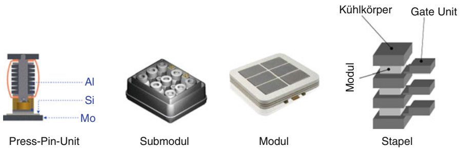
Abb. 7.13 Aufbau eines IGBT-Stapels. (Quelle: ABB)
