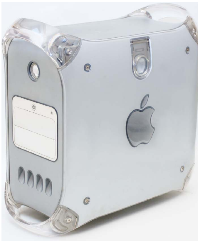
Der Power Mac G4 Quicksilver MDD (mirrored drive doors) benötigt riesige Luftauslässe für enorm laute Lüfter. Apple-Kunden sehnen sich nach Stille.
