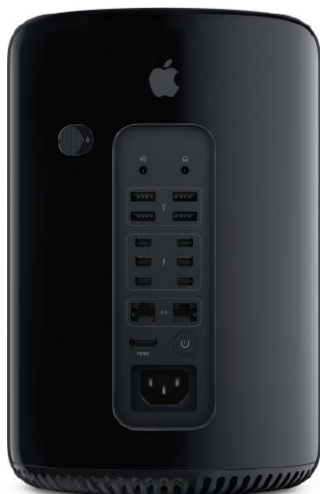
Vier Thunderbolt-Buchsen sind für den neuen Mac Pro die Verbindung zur Welt der Erweiterungen.
