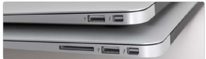
Rechts bietet das Macbook Air einen Thunderbolt- und einen USB-3.0-Anschluss, die 13-Zoll-Variante zusätzlich einen SD-Steckplatz.
