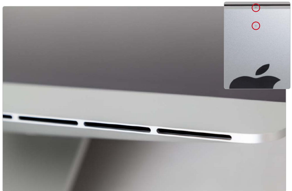
Großes Bild: Die Lüftungsschlitze dienen als Öffnung für die Lautsprecher. Kleines Bild: zwei Mikrofone an Bord.
