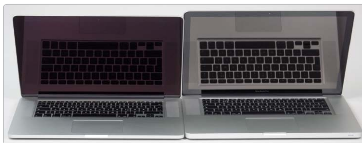
Im direkten Vergleich die Display-Spiegelung des Macbook Pro Retina (links) und des Macbook Pro (rechts).
