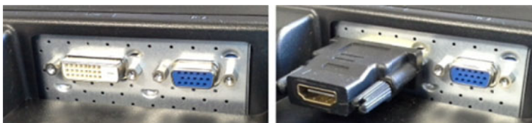
Abbildung 1.9: Dieser Monitor verfügt über zwei Anschlüsse, wobei die DVI-Buchse mit einem Adapter (rechts) auf eine HDMI-Buchse umgesetzt werden kann.
