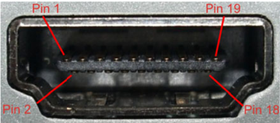
Abbildung 3.13: Die Kontakte der HDMI-Buchse
