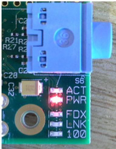
Abbildung 1.13: Die Spannung liegt an (PWR-LED) und das System bootet (ACT-LED).
