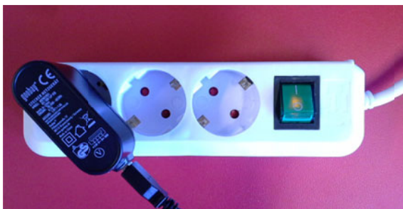
Abbildung 1.6: Nichts Besonderes ist eine simple schaltbare Steckdosenleiste, womit der Raspberry Pi ein- und ausgeschaltet wird, allerdings kann sie einen vor Missgeschicken mit der Spannungsversorgung bewahren.
