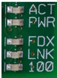
Abbildung 6.2: Die Leuchtdioden auf dem Raspberry Pi Board
