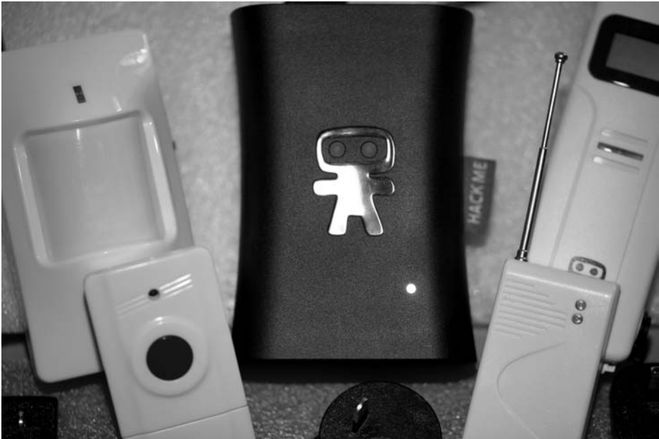
Bild 2.124: Preiswerter Einstieg in die Heimautomation: viel China-Plastik, jedoch geschickt und durchdacht gekoppelt – Bewegungsmelder, Funktürklingel, Ninja Block, Funktür-/fensterkontakt mit Antenne, Temperatur-/Feuchtigkeitssensor (von links nach rechts).
