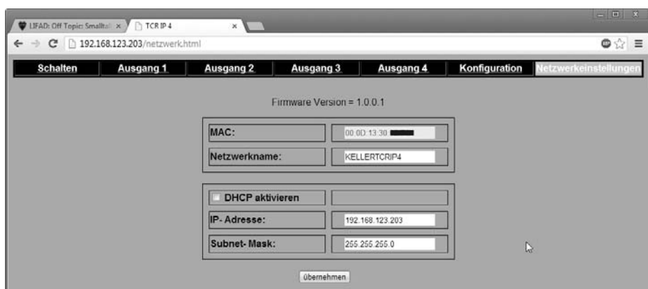
Bild 2.60: Netzwerkeinstellungen: In diesem Fall wurde trotz vorhandenem DHCP-Server eine statische IP-Adresse aus dem Heimnetz verwendet. Damit ist die Nutzung des TCR IP 4 auch dann möglich, wenn der DHCP-Server aus irgendeinem Grund einmal ausgeschaltet sein sollte.
