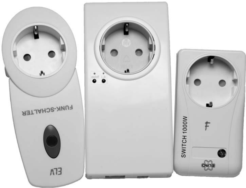
Bild 2.57: Von links nach rechts: Die ELV-FS20-Funksteckdose ist seit Jahren ein Klassiker, in der Mitte sehen Sie die edle Rutenbeck-Steckdose TC IP 1 in Reinweiß sowie rechts eine China-Funksteckdose, die unter verschiedenen Herstellerbezeichnungen am Markt zu finden ist.
