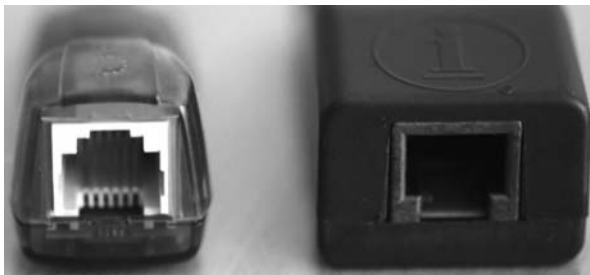
Bild 2.28: Links der blaue DS9490R (DS1490F), rechts der schwarze DS9097U-COM-to-1-Wire-USB-Adapter
