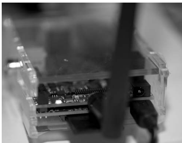
Bild 1.9: Kein Schönheitspreis, aber zweckmäßig: In diesem Fall wurde einfach das Seitenteil des Gehäuses nicht genutzt, um den Raspberry Pi samt COC-Erweiterung und verbauter Antenne in ein Gehäuse zu zwängen.
