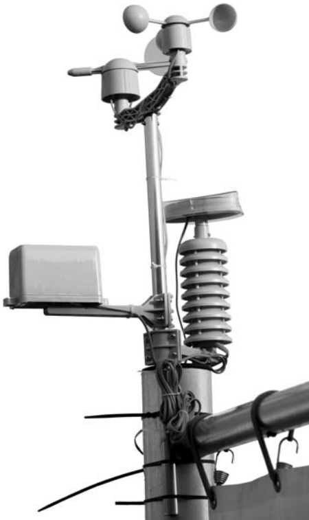
Bild 2.43: Viele Kabelbinder: Um die Wetterstation stabil zu befestigen, nutzen Sie am besten solide Kabelbinder oder Schraubschellen aus Metall, damit der Mast der Wetterstation auch Wind und Wetter standhält. Prüfen Sie die Kabelbinder spätestens alle sechs Monate auf ihre Stabilität, da sie durch den Einfluss von Wind und Wetter mit der Zeit spröde werden und dann leicht brechen können.
