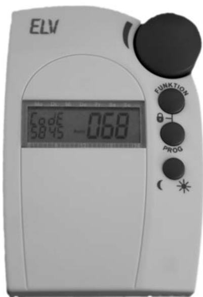
Bild 2.121: Synchronisation: Der Funkthermostat muss in den Programmier-Mode geschaltet werden, um mit dem FHT-ID-Code der Steuereinheit gekoppelt zu werden.
