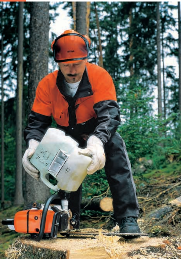
Betanken der Motorsäge: nur mit Einfülltrichter.
