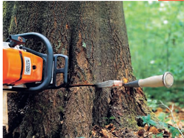
Keile unterstützen den Fällprozess.
