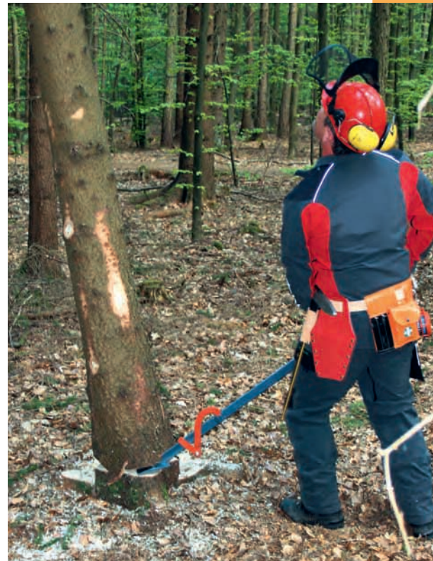
Einsatz des Fällhebers beim Baumfällen.
