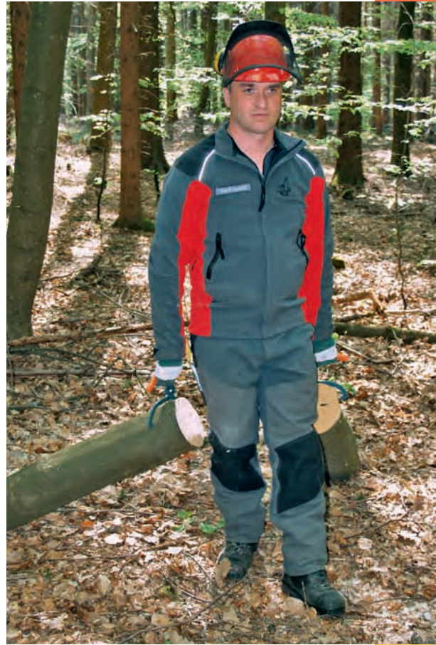
Transport der Abschnitte mit der Packzange.
