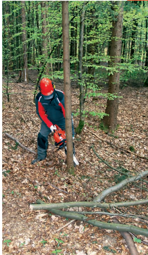
Schräger Fallschnitt bei einem dünnen Baum.
