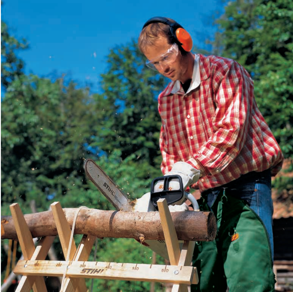
Ablängen mithilfe eines Sägebockes: So wird die Wirbelsäule entlastet.
