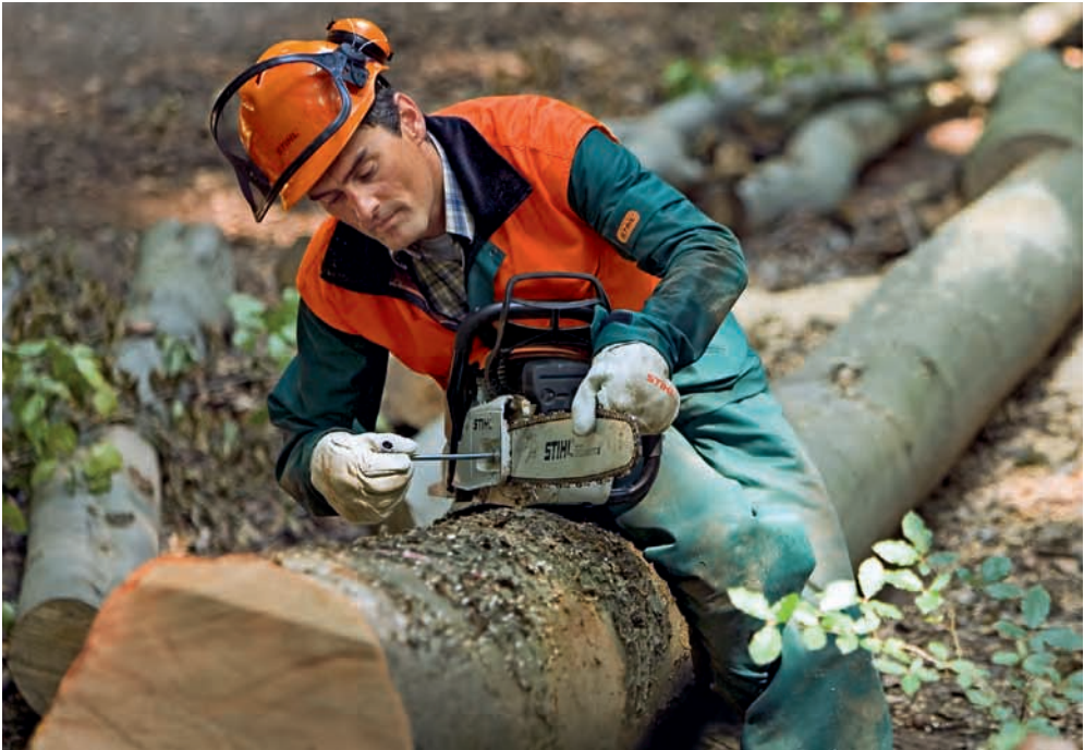
Während der Arbeit muss die Kette immer wieder nachgespannt werden.
