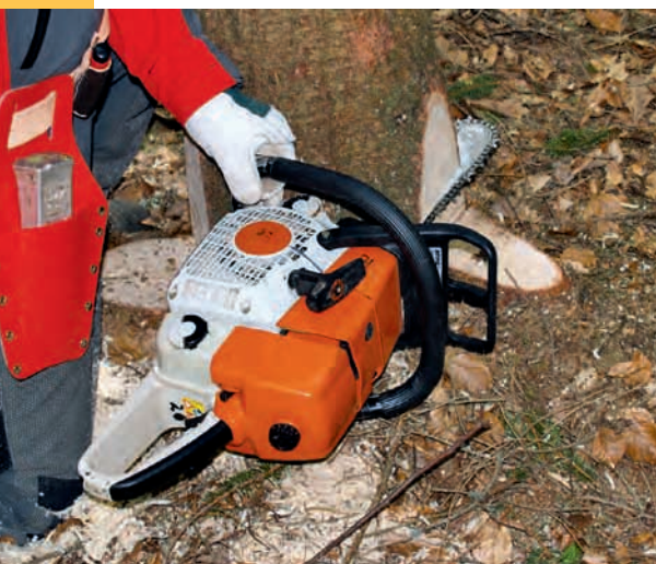
Die Richtung des Fallkerbs wird geprüft.
