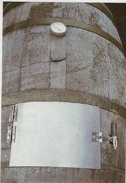
sogar ein selbst gebauter Räucherofen. Letzterer kann aus einer ausgedienten Tonne oder aus einem Stück Stahlrohr von 1,20 bis 1,50 m Länge angefertigt werden. Der Durchmesser sollte etwa 30 bis 40 cm betragen.
