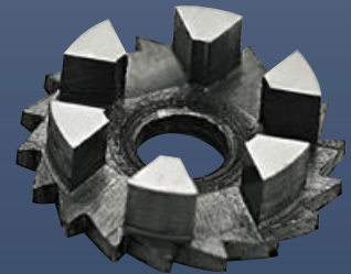
Die sechs Säulen oder Kolonnen des Schaltrads regeln die Abfolge von Start, Stopp und Nullstellung. Die Wolfsverzahnung unterhalb der Säulen dient dazu, dass die Schaltklinke (links) das Schaltrad weiterbewegen kann
