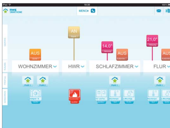
Alles auf einen Blick: In der App sind alle Geräte zu sehen. Mit Tippen oder Ziehen ändert man Schaltzustände oder Temperaturen.
