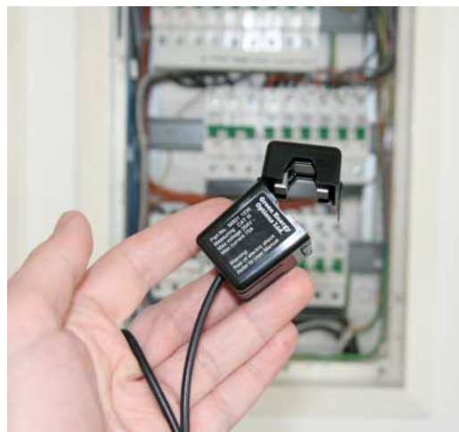
Über Messklammern an der Hauszuleitung bestimmt das Geo-System per Induktion den aktuellen Stromverbrauch.
