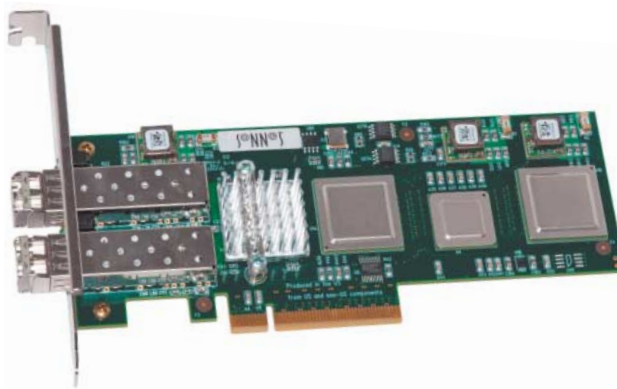
Die Sonnet Presto 10GbE Server 2-Port mit installiertem Transceiver-Modul
