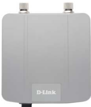
Die wetterfeste WLAN-Basisstation DAP-3520 von D-Link trotzt dank eingebauter Heizung auch niedrigen Temperaturen.
