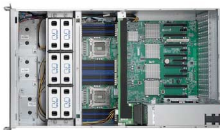
In die Rack-Einschübe von Gigabyte (GS-R22PHL, rechts) und Tyan (FT77A-B7059) passen je acht PCIe-3.0-Rechenbeschleuniger.
