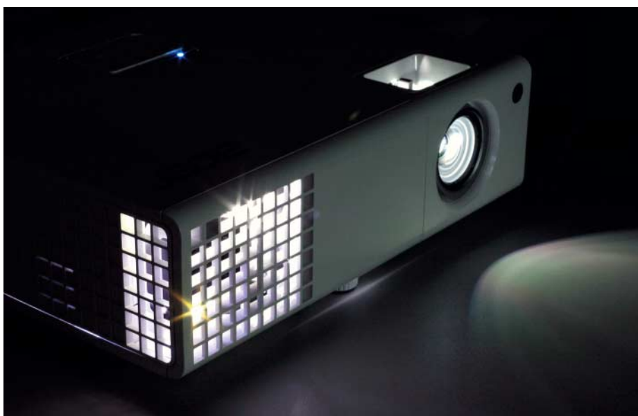
Kann nerven: Bei den günstigen DLP-Projektoren (hier Acer H6510BD) tritt sehr viel Licht aus den Lüftungsöffnungen.
