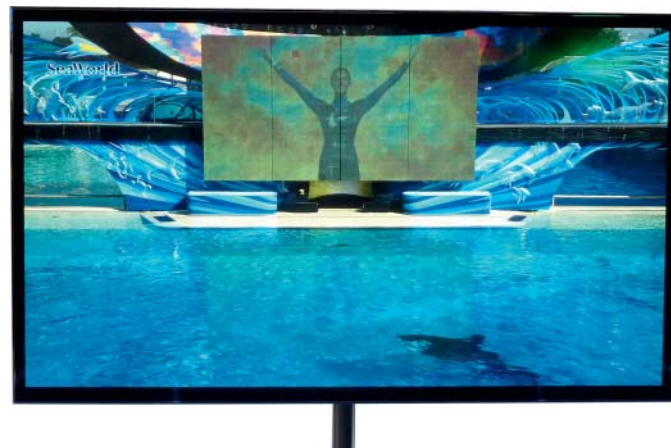
Die Leuchtschichten in Panasonics 4K-OLED wurde mit Polymeren von Sumitomo gedruckt. Farbfilter über der organischen Schicht sorgen für sattere Farben.
