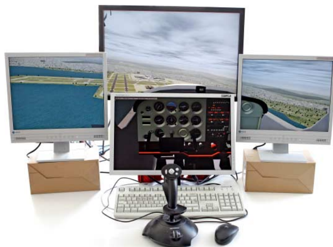
Das Vier-Monitor-Setup in der Praxis: Für längere Simulatorflüge stellt man die beiden Hauptmonitore übereinander und schließt die zwei Zusatzmonitore an.
