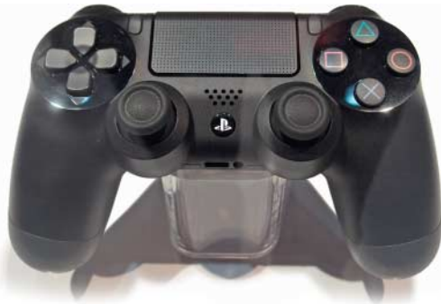
Der PS4-Controller soll schneller reagieren und feinfühler vibrieren. Das hochauflösende Touchpad erkennt zwei Berührungen gleichzeitig.
