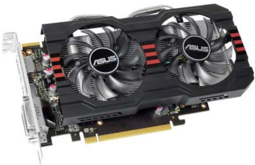
Asus' Radeon HD 7790 setzt auf den leisen DirectCU-II-Kühler.
