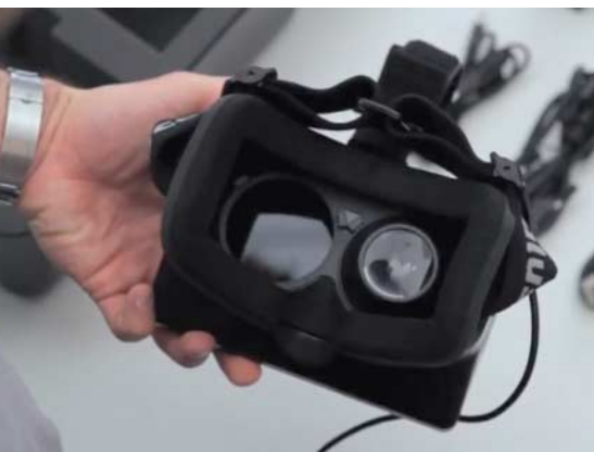
Drei Paar Dioptrien-Ausgleichslinsen liegen der Oculus-Rift-Brille bei, sie soll aber auch mit einer konventionellen Brille komfortabel funktionieren.
