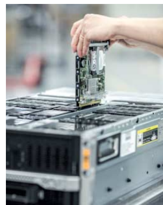
Von den kleinen Servermodulen passen 45 Stück in das Moonshot-Chassis.
