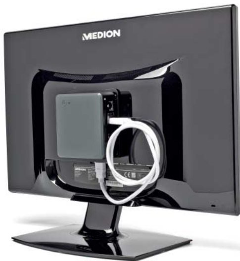
Der NUC verschwindet auf Wunsch hinter einem Flachbildschirm mit Vesa-Gewindebohrungen.
