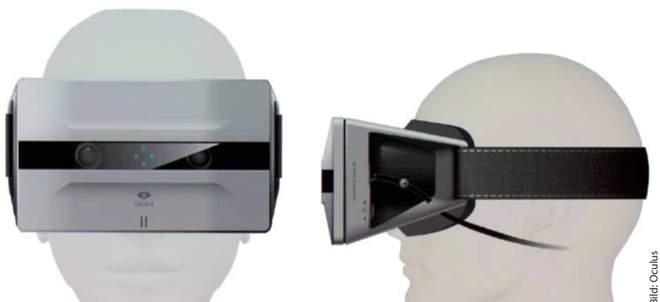
Erste Konzept-Bilder von der Consumer-Variante der Oculus Rift zeigen eine Brille mit Full-HD-Display und Stereo-Kamera. Sie soll im dritten Quartal 2014 erscheinen. ct
