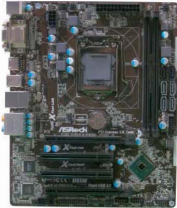
Für LGA1150-Mainboards wie das Asrock B85M fertigt Intel ein neues Chipsatz-Stepping.
