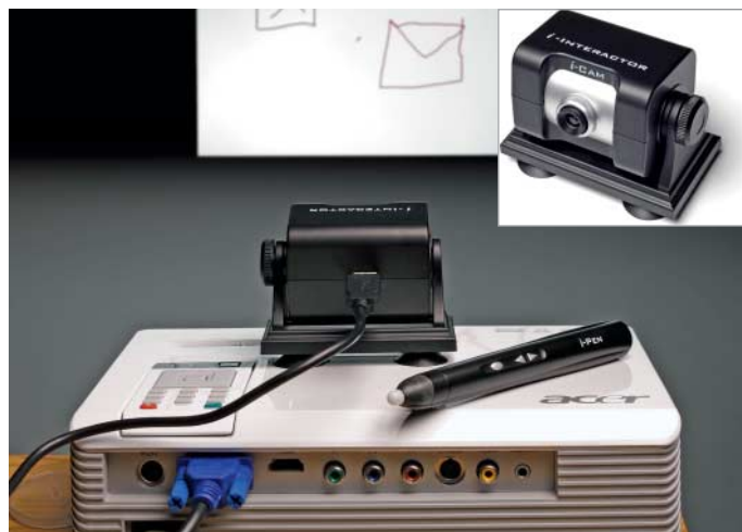
Die i-Interactor-Kamera lässt sich mittels Saugfüßen auf einem Beamer befestigen. Der Stift besitzt außer dem Spitzenkontakt Tasten für die rechte Maustaste und zum Blättern.
