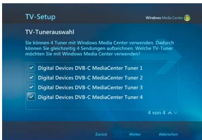
Bis zu acht Kabel-Tuner schiebt DigitalDevices dem Windows Media Center als Satellitenempfänger unter. Der Kabelanbieter erscheint während der TV-Einrichtung als zusätzlicher „Satellit“.
