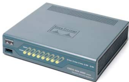
Cisco ASA 5505: Überwachung per Java-Tool, kann Anzahl der Extension Header limitieren, ignoriert manche RFCs
