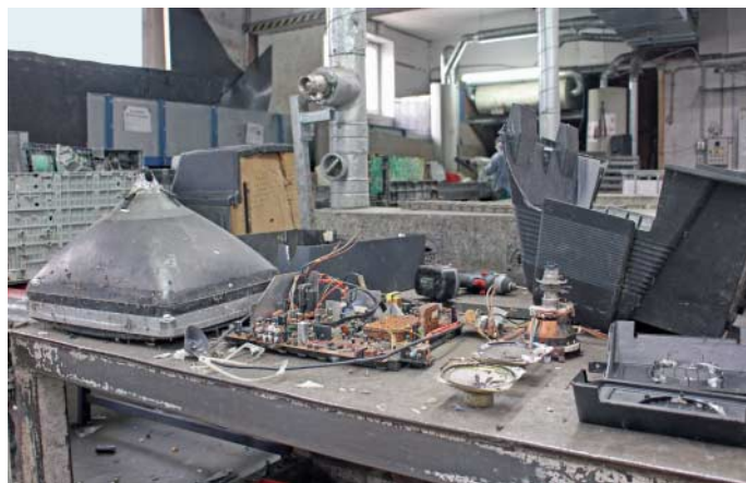
Beim Zerlegen eines Bildschirms fliegen schon mal Plastikstücke durch die Gegend – und Wertstoffe direkt in die Sammelcontainer. Jede Bildröhre wird in 5 bis 7 Minuten von Gehäuse, Metallen, Ablenkeinheit, Platinen, Kabeln und Zubehör befreit.
