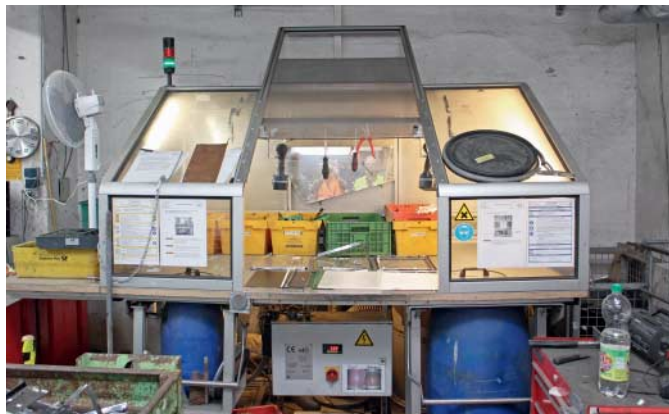
Da die quecksilberhaltigen Kaltkathodenstrahler im Backlight teilweise zerbrochen sind, werden LCDs bei Elpro nur in einer gut belüfteten Kabine zerlegt.
