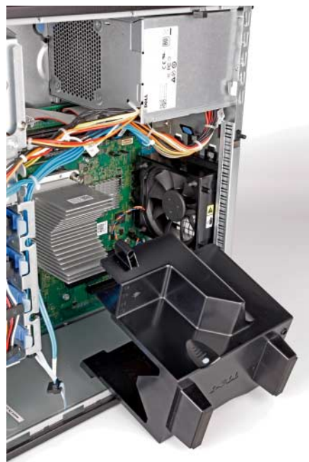
Die Spezialgehäuse der großen Server-Marken lassen sich oft ohne Werkzeug öffnen und ermöglichen gezielte Kühlung.
