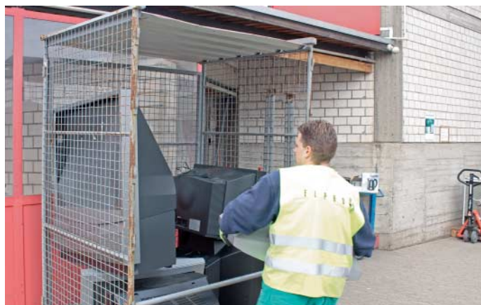
Werden die Röhrengeräte in großen Containern gestapelt, geht beim Transport so manches Glas kaputt. Besser gelingt das zerstörungsfreie Ein- und Ausladen mit speziellen Gitterboxen.
