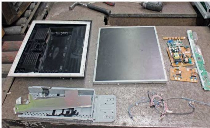
Zweistufiges Flachbildschirm-Recycling: Zunächst werden die Geräte in Gehäuse, Platinen, Metalle, Kabel und LCD-Panel zerlegt (links), und anschließend das Panel selbst in seine Bestandteile Glas, CCFL-Röhrchen, Diffuser-Folien, Lichtleiterplatten sowie Platine, Alurahmen und Bleche getrennt.
