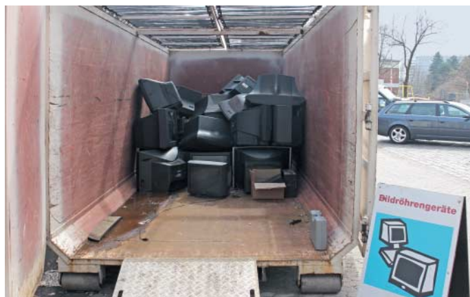
Beim Zerlegen eines Bildschirms fliegen schon mal Plastikstücke durch die Gegend – und Wertstoffe direkt in die Sammelcontainer. Jede Bildröhre wird in 5 bis 7 Minuten von Gehäuse, Metallen, Ablenkeinheit, Platinen, Kabeln und Zubehör befreit.
