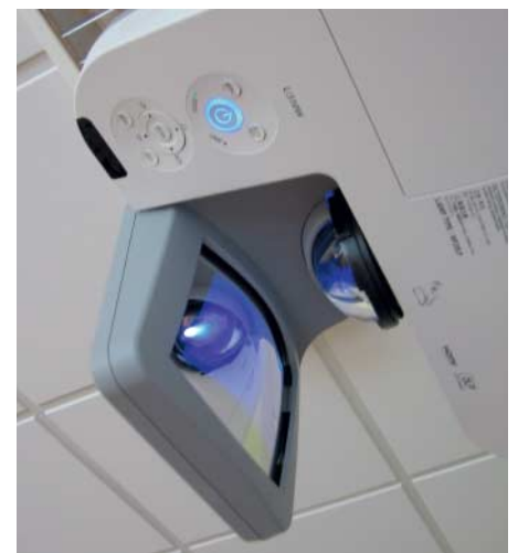
Die Projektion übernimmt ein Ultrakurz-distanz-Beamer mit Spezialoptik und Umlenkspiegel von oben.
