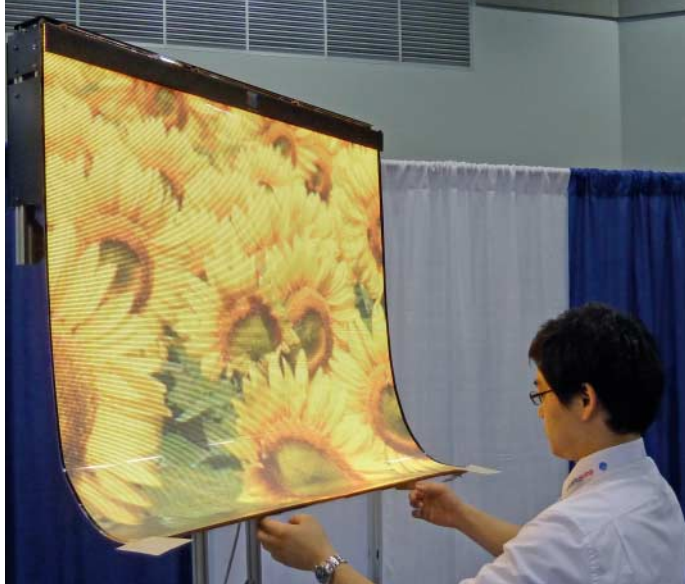
Der brizzelnde Plasmavorhang von Shinoda lässt sich biegen, die Pixeldichte von 8 dpi empfiehlt den Schirm eher als Großleinwand.
