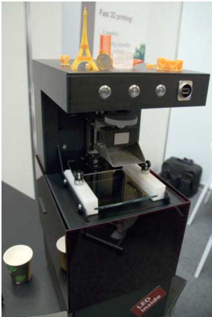
Auch wenn ein Becher danebensteht: Der S30 ist keine Espressomaschine, sondern ein 3D-Drucker, der durch das Licht einer Beamerprojektion Kunststoff aushärtet und dabei eine Auflösung von 20 Mikrometern erreicht.
