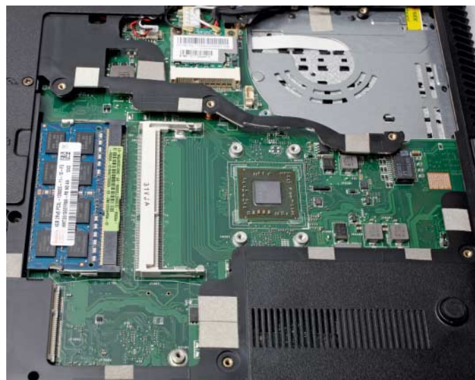
AMDs A4-5000 (Mitte) enthält außer x86-Kernen und DirectX-11-GPU auch alle Chipsatz-Schnittstellen wie USB 3.0 oder SATA.
