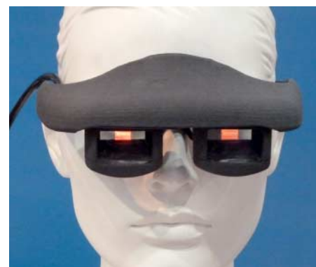
Das Brillengestell für das bidirektionale OLED-Display haben die Entwickler des Fraunhofer Comedd selbst gedruckt.
