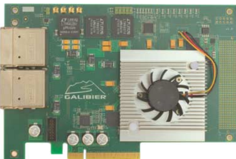
Extoll Galibier: Die Adapterkarte für den Cluster-Interconnect ist bisher noch mit FPGAs bestückt.
