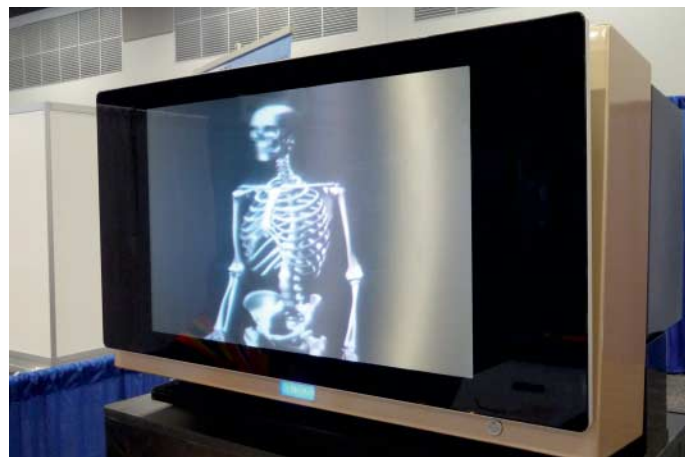
Nach Lichtfeld-Kamera kommt Lichtfeld-Display: Das 3D-Display von Holografika zeigt Objekte von allen Seiten.
