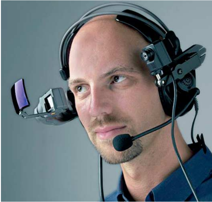
HMD der Firma Xybernaut aus dem Jahr 2002. Zusammen mit einem am Gürtel getragenen Rechnersystem enthielt der „Mobile Assistant V“ schon viele Elemente einer modernen Datenbrille – nur eben viel klobiger.
