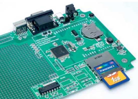
Der Color Maximite von CircuitGizmos ist mit Echtzeituhr, Lochrasterfeld und einem RS-232-Pegelumsetzer ausgestattet.
