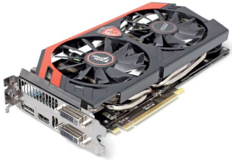
Die Twin-Frozr-Variante von MSI ist beim Spielen dank ihrer beiden Axiallüfter sehr leise und lässt sich gut übertakten.
