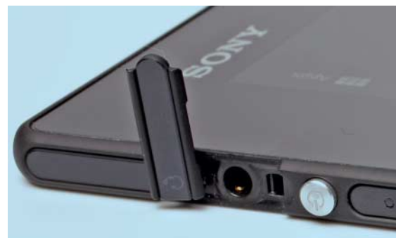
Die Anschlüsse stecken beim Xperia Tablet Z hinter wasserdichten Klappen.
