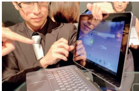
Asus Transformer Book Trio: Im Display steckt ein Android-Tablet mit Atom-CPU, im Rumpf ein Windows-PC mit Core i.
