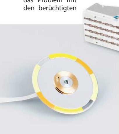
Osrams Phaser-Modul (oben) erzeugt Farben mit einem mit grünem, rotem und gelbem Leuchtstoff beschichteten Rad (links). Das blaue Laserlicht kommt unverändert durch die beiden schmalen Lücken aufs Panel.
