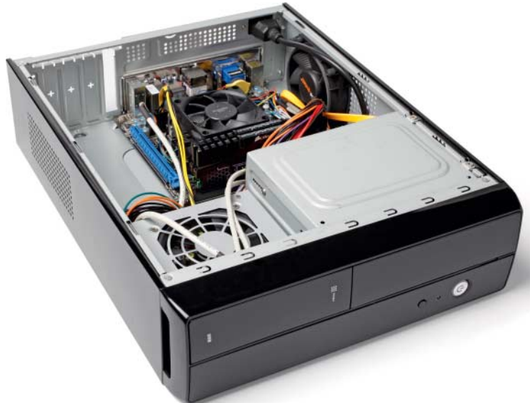
Die AMD-APUs eignen sich besonders für kompakte Rechner mit vergleichsweise starkem 3D-Schub wie die c't-Steam-Box.
