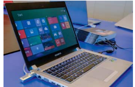
Gigabyte bringt das Kunststück fertig, den 48-Watt-Haswell und Nvidia GTX 760M in einem 14-Zoll-Notebook unterzubringen.
