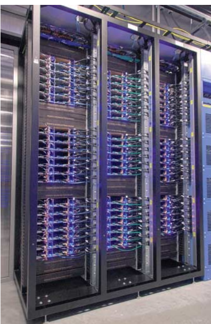
Das typische Drillings-Rack für Server nach OCP-Spezifikation.
