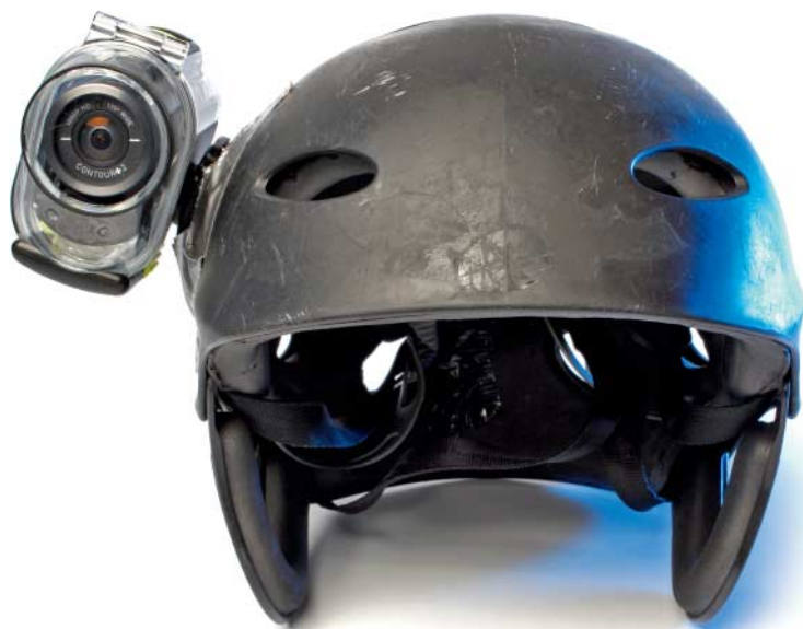
Kletterkunststück: Schief haftet die Kamerahalterung am Schutzhelm. Für die notwendige Korrektur der Bildachse verdreht man die Optikeinheit in der Action-Cam.
