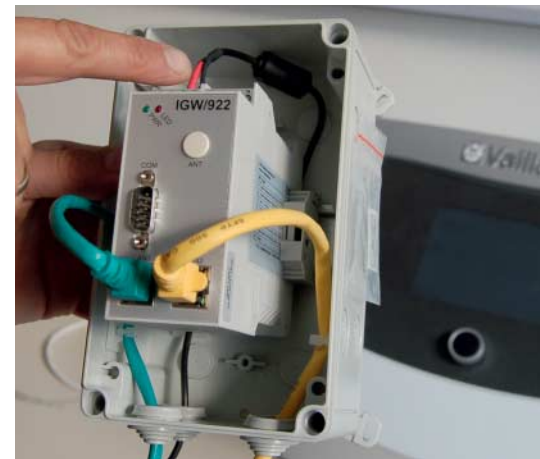
Der Heizungshersteller Vaillant schottet die löchrigen Steuermodule jetzt durch eine VPN-Box gegen unerlaubte Zugriffe ab.
