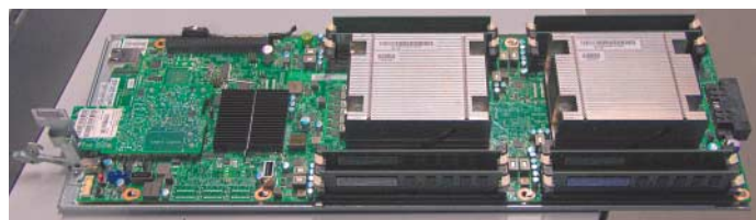
Lang und schmal: Die beiden Xeons sitzen auf Intels OCP-Mainboard 2.0 hintereinander.
