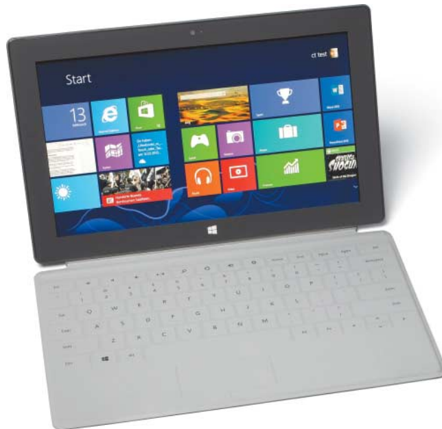
Im Windows-Tablet Microsoft Surface steckt ein TPM 2.0. Es ist in das ARM-SoC integriert – in diesem Fall kommt ein Tegra 3 von Nvidia zum Einsatz.
