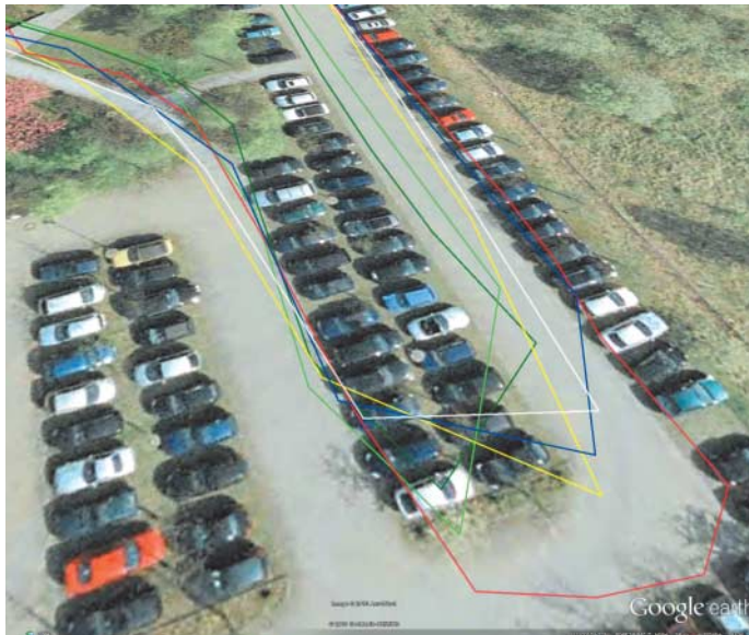
Die Genauigkeit der GPS-Empfänger ist für die Straßennavigation ausreichend, die Abweichungen vom gelaufenen Weg liegen unter 10 Metern (rot: Apple iPhone 5, hellgrün: BlackBerry Q10, weiß: HTC One, dunkelgrün: Nokia Lumia 925, gelb: Samsung Galaxy S4, blau: Sony Xperia Z).
