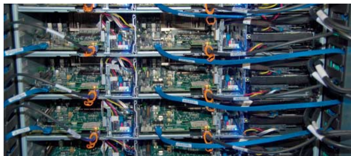
Je zwei Server arbeiten im „Windmill“-System nebeneinander, rechts die zugehörigen Festplatten, dahinter das Netzteil.
