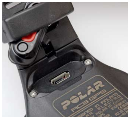
Die meisten Sportuhren nutzen für die Datenverbindung proprietäre Anschlüsse, an die USB-Kabel mit Klemme kommen. Polar (rechts) setzt bei der RC3 GPS auf Micro-USB.
