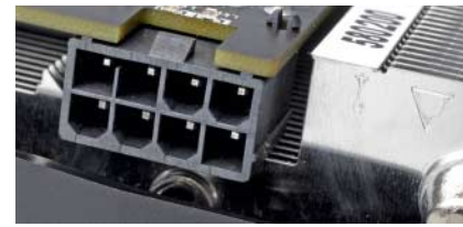
Asus versorgt seine GTX 760 über einen 8-Pin-Anschluss.
