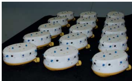
Die Schwarmroboter des CoCoRo-Projekts nutzen unter anderem optische Verfahren für die Verständigung unter Wasser.
