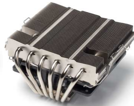
Der Silverstone Nitrogen NT06-PRO passt in kompakte Gehäuse. Der mitgelieferte Lüfter macht bei Volllast aber viel Krach.
