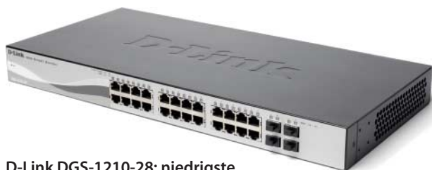
D-Link DGS-1210-28: niedrigste Leistungsaufnahme im Test dank wirksamer Energiesparfunktionen, Zeiteinstellung noch optimierbar
