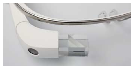
Google Glass dürfte auch in der finalen Version ein LCoS-Mikrodisplay nutzen.
