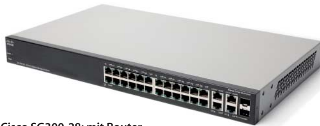
Cisco SG300-28: mit Router-Advertisement-Filter und bestem Funktionsumfang aller Prüflinge, aber im Test mäßig wirksames Energiesparen (EEE)
