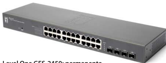
Level One GES-2450: permanente Verzögerung beim Verbindungsaufbau trotz korrekter Radius-Authentifizierung, Verwaltung per IPv6 nur über Browser
