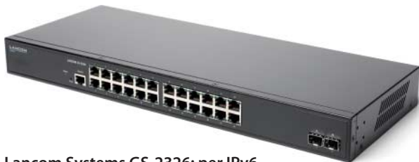
Lancom Systems GS-2326: per IPv6 steuerbar, sehr hohe Zahl aktiver VLANs, Switch ist per Virtual Stacking zu größeren Systemen koppelbar
