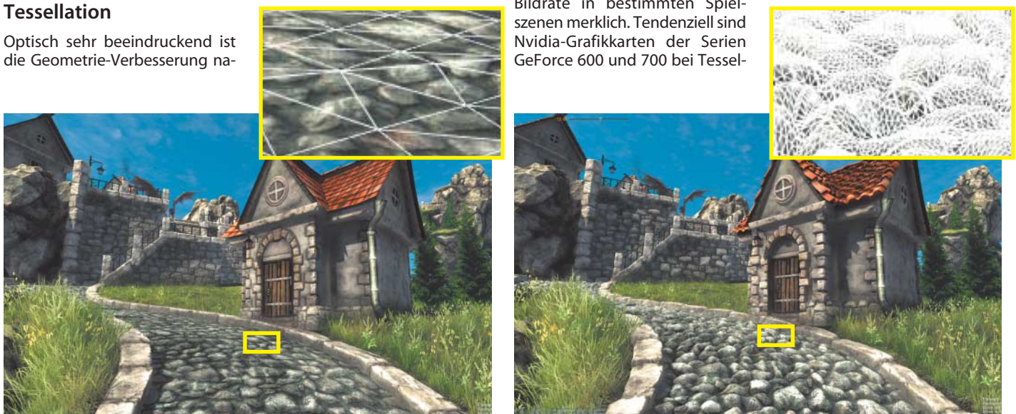
Der DirectX-11-Effekt Tessellation verfeinert geometrische Strukturen und sorgt so für einen plastischen Eindruck. Das drückt aber auch auf die Bildrate: In der gezeigten Szene fällt sie mit Tessellation 30 Prozent niedriger aus.
